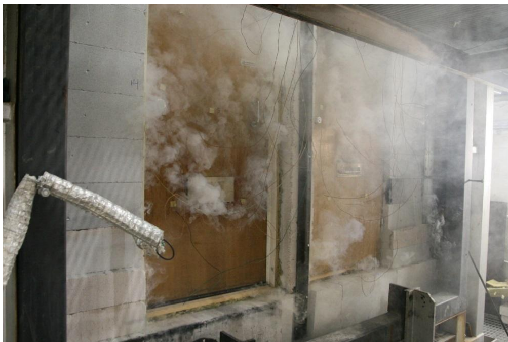
Kuva 11. Polttokokeen alusta on kulunut kolme minuuttia. Ovet täyttävät vielä palo-ovien lämmöneristävyydelle ja liekkitiiveydelle asetetut vaatimukset.
