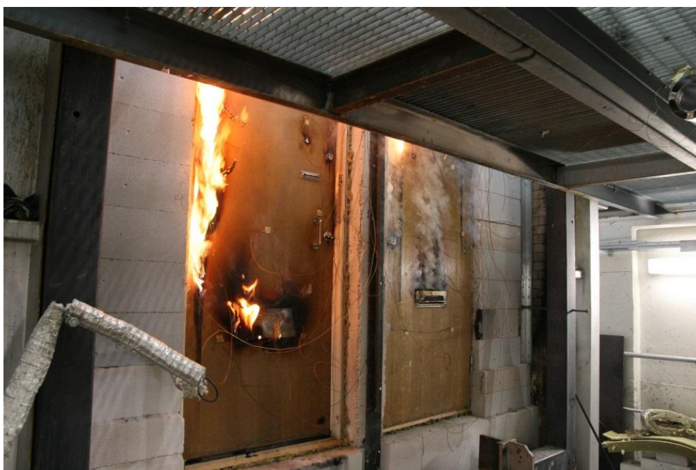
Kuva 12. Polttokokeen alusta on kulunut 22 minuuttia. Ovien olisi pitänyt kestää 30 minuuttia.
