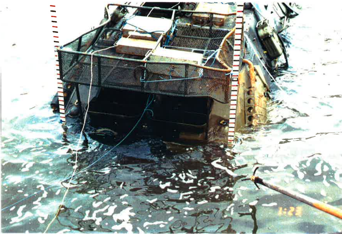
Kuva L7.14 Upotuskoe 2. Vaunu on juuri laskettu veteen ja vesi on vähän ilmanpoistoaukkojen alareunan yläpuolella.
