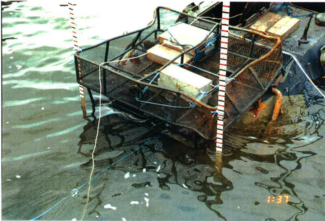
Kuva L7.17 Kaksi minuuttia myöhemmin. Vesi syöksyy sisään ja vaunu uppoaa.
