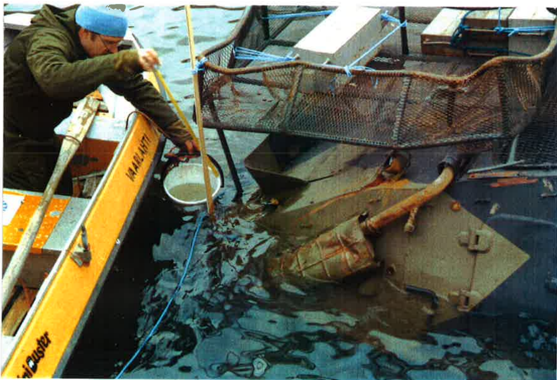
Kuva L7.5 Vaunu onnettomuustrimmissä. Äänenvaimentimen alapuolella näkyy tyhjennyspumpun läpiviennin suojuus.
