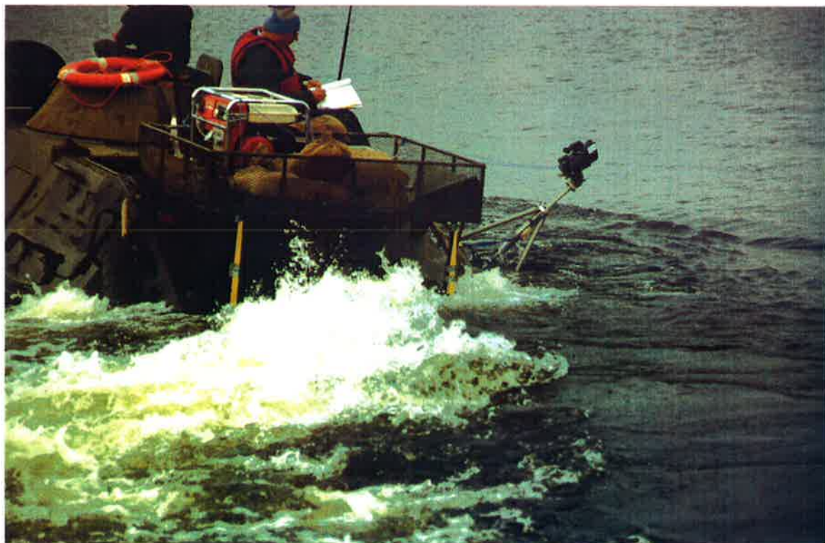
Kuva L7.11 Kaari vasemmalle, jolloin vaunu kallistuu oikealle.
