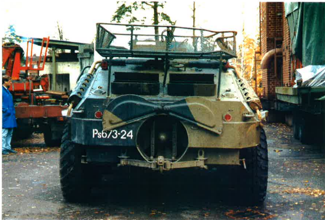
Kuva L7.2 Onnettomuusvaunu takaa. Tavarateline, ilmanpoistoaukot ja niiden suojakourut näkyvät kuvasta hyvin.
