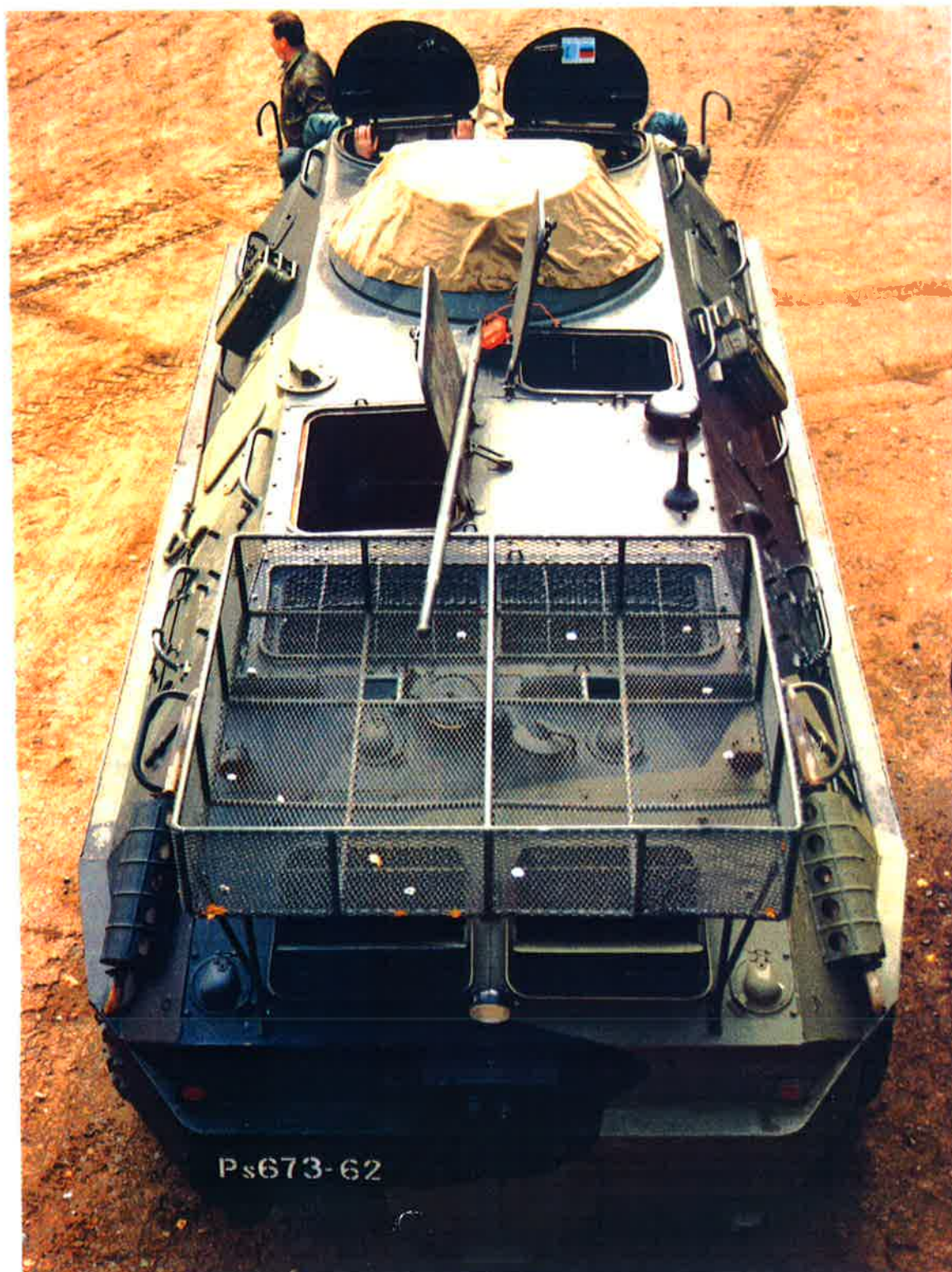
BTR-60 PB-miehistönkuljetuspanssarivaunu takaapäin. Kuvan vaunu ei ole onnettomuusvaunu. Kannen peräosassa, osittain taakkatelineen alla näkyvät poistoilma-aukot, joiden kaihtimet ovat auki.
