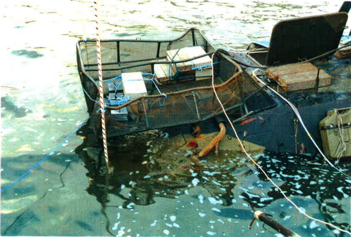
Kuva L7.18 Vaunu 4 b upotuskokeessa. Kaihtimet kiinni tilanteessa nopea uppoaminen alkoi vasta kun jäähdytysilman imuaukot painuivat veteen. Tämä hidasti uppoamista kahdella minuutilla.
