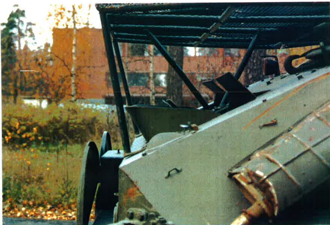
Kuva L7.3 Kuva suojakouruista. Kaihtimet ovat auki-asennossa
