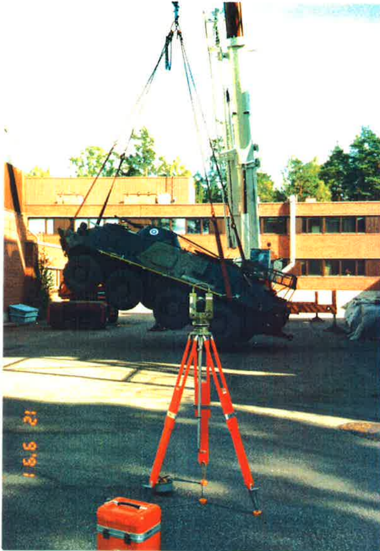
Kuva L7.6 Vaunu ripustettu painopisteen määrittystä varten.
