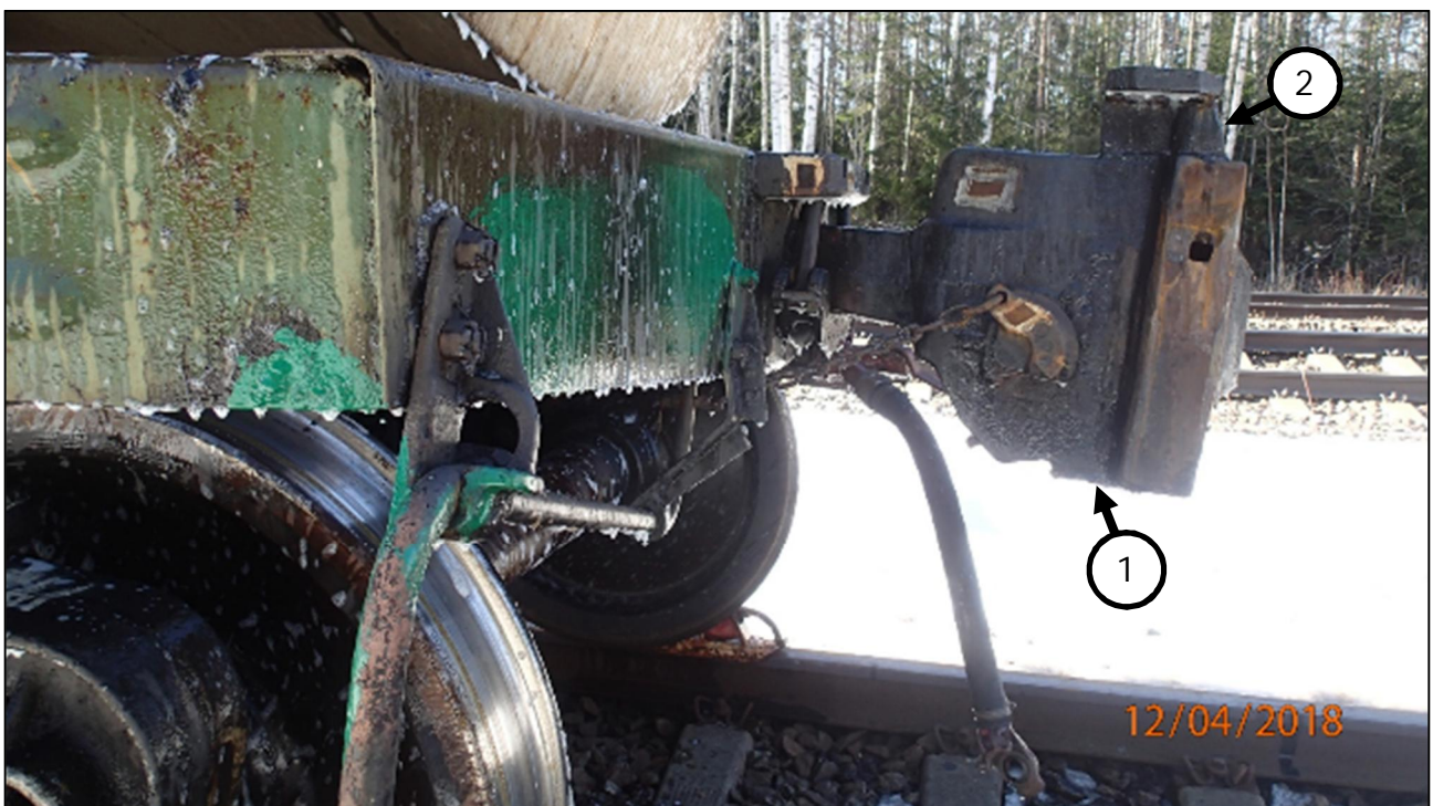
Kuva 15. Toisen vaunun etupään keskuspuskin, joka lävisti ensimmäisen vaunun säiliön päädyn. Keskuspuskimen alapuolen ylisyoöksynestin on revennyt irti (1), yläpuolella ylisyoöksynestin on paikoillaan (2). (Kuva: OTKES)
