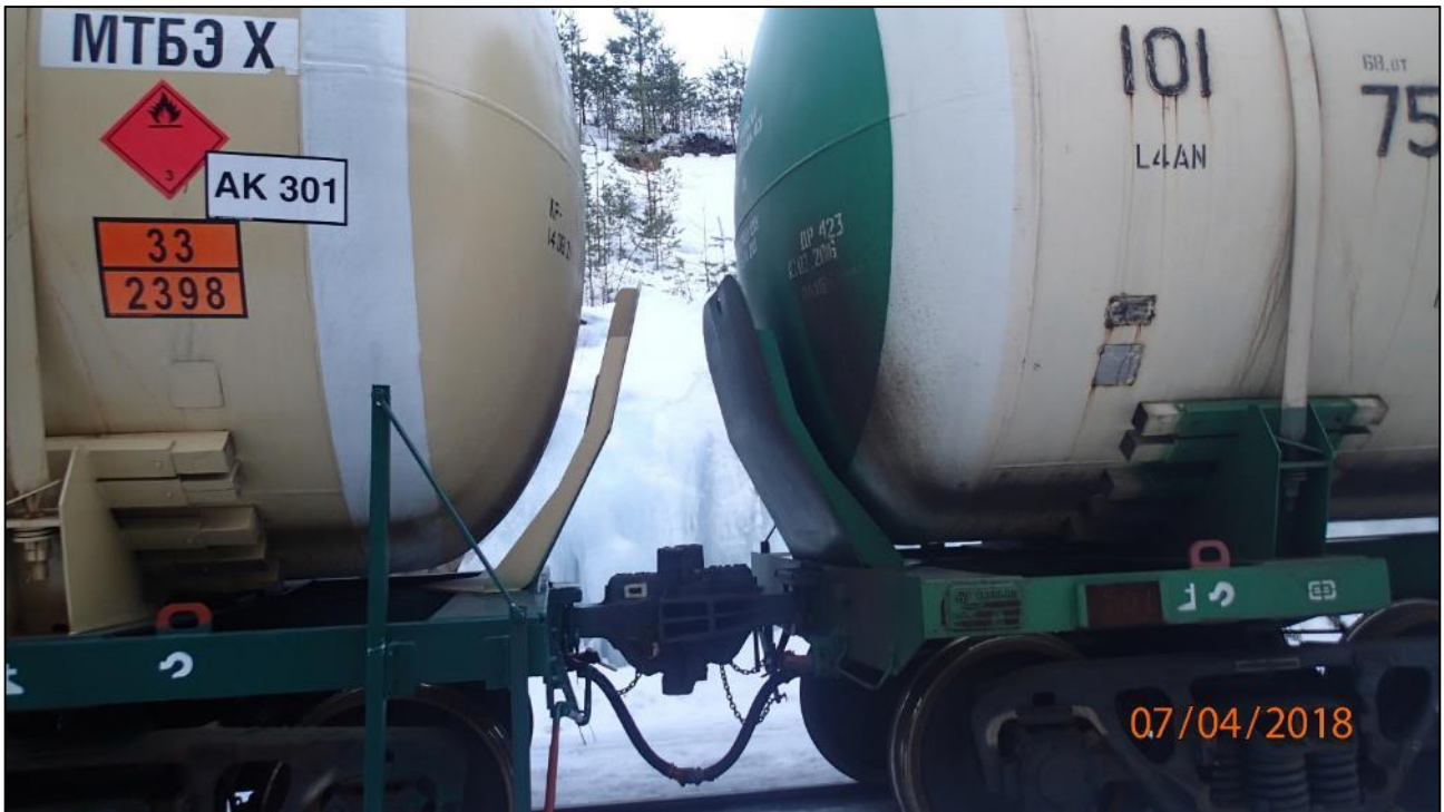
Kuva 16. Vaunuja, joissa säiliön päätyjen edessä turvapäädät. (Kuva: OTKES)
