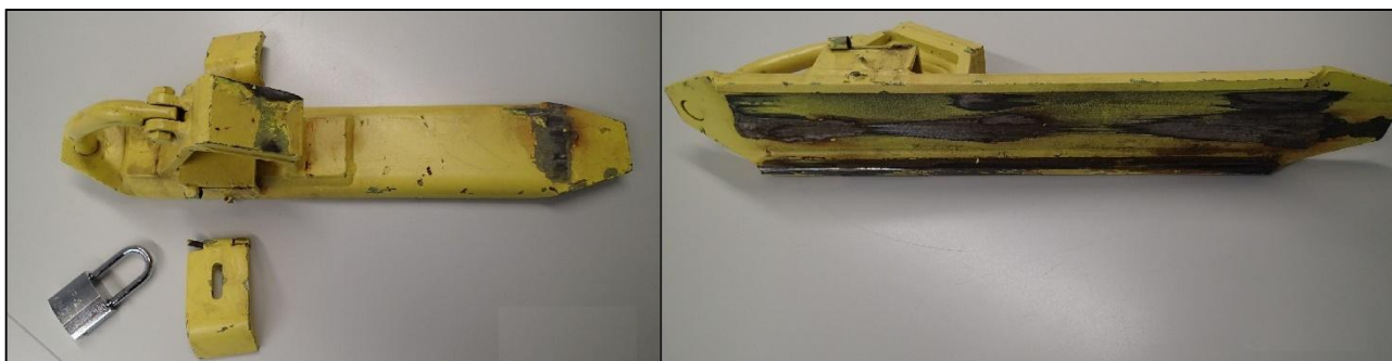
Kuva 12. Läntisellä kiskolla ollut lukittava pysäytyskenkä. (Kuva: OTKES)
