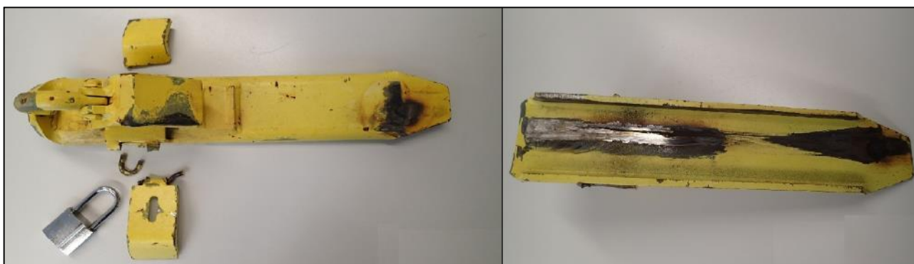
Kuva 11. Itäisellä kiskolla ollut lukittava pysäytyskenkä. (Kuva: OTKES)
