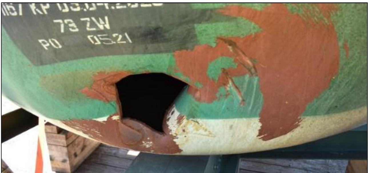
Kuva 13. Ensimmäisen vaunun pätylaippaan törmäyksessä syntynyt reikä. (Kuva: OTKES)
