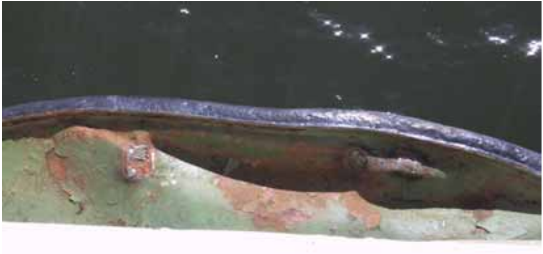
Kuva 7. Aluksen törmäyslistaan ja kanteen tulleet taipumat kuvattuna ylhäältä.
