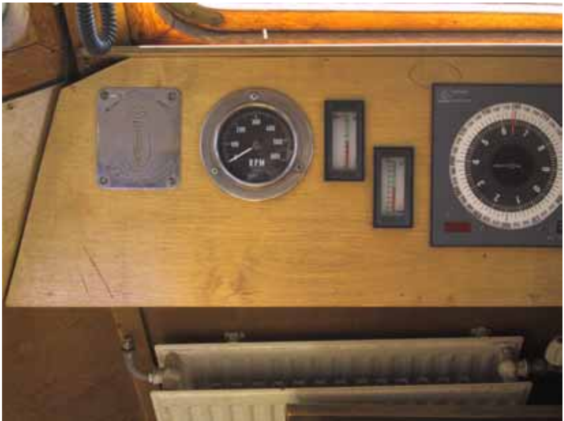
Kuva 11. Peräohjaamon mittaritaulu, vertaa kuvat 3 ja 4. Keskellä on kaksi lapakulmaindikaattoria.
