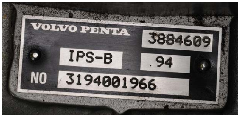
Kuva 2. Vetolaitteen tyyppikilpi. Tyyppi B, alennussuhde 1,94:1
