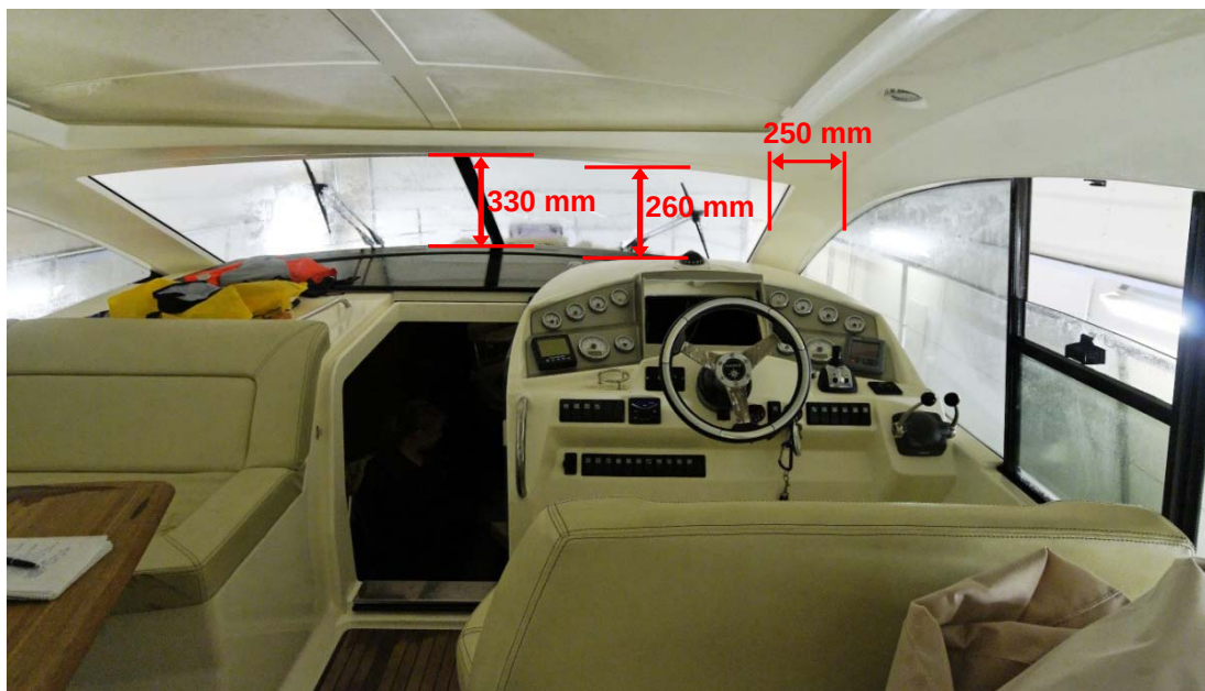
Kuva 15. Yleisnäkymä ohjaamosta kuljettajan paikan takaa. Kuva on otettu onnettomuusveneessä korjaushallissa pian veneen nostamisen jälkeen. Tuulilasin korkeus on 330 mm, ohjauspulpetti rajoittaa näkyvyyttä alaosasta siten, että tehollinen korkeus näkyvyydelle on 260 mm. Sivupilarin leveys on 250 mm.
