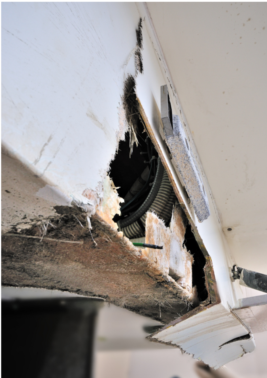
Kuva 33. Näytepalan leikkaamisen jälkeen otetusta kuvasta näkyy selkeästi miten peräpeili ja pohja ovat revenneet irti toisistaan. Lujitekerroksia ei ole vuorotellen limitetty vaan ensin on tehty peräpeili ja sen päälle (muotissa) on lami-noitu veneen pohja. Irtoaminen on tapahtunut osien välistä saumaa pitkin. Kuvasta näkyy myös huolimattomasti peräpeilin ja IPS-asennusrenkaan vä-lille liitetty polvio.
