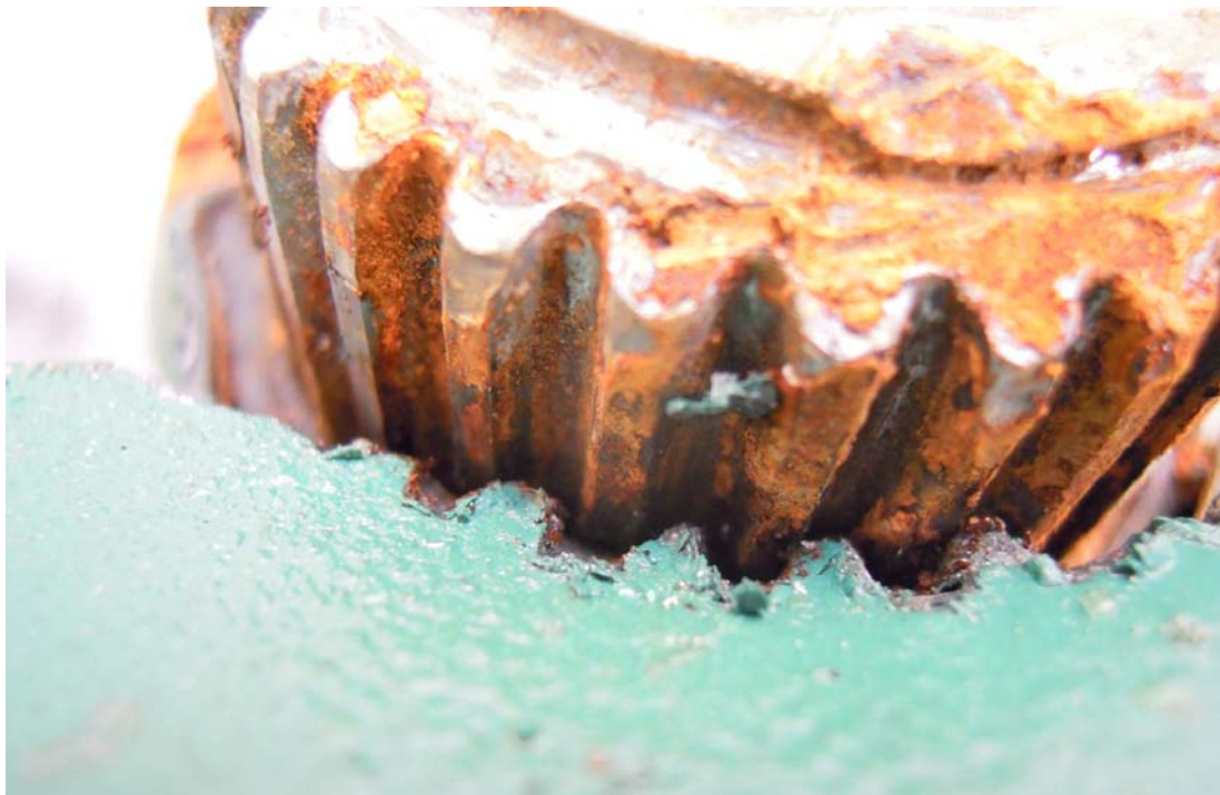
Kuva 24. Vetoakselin hammastus sopii yhteen murtuneen yhdyskotelon jälkien kanssa osoittaen, että akseli on voimalla lyönyt koteloon.
