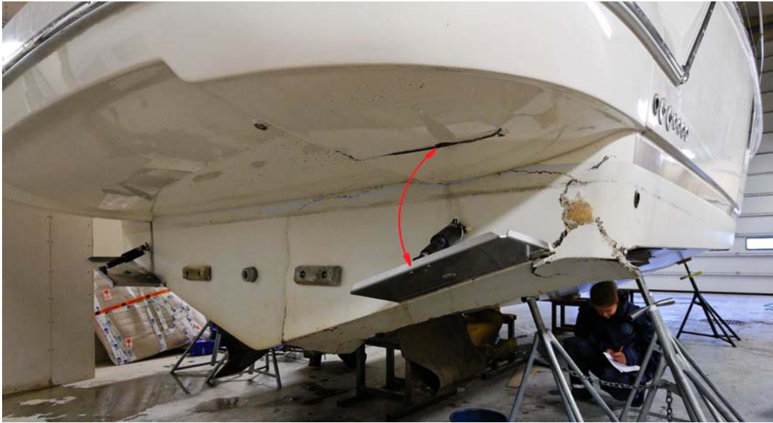
Kuva 21. Veneen peräpeili. Törmäyksessä pohjalevyn ja peräpeilin laminaatit irtosivat toisistaan avaten puolen peräpeilin levyisen raon veneen pohjaan. Tästä raosta ja irti murtuneen IPS-vetolaitteen aukosta vesi täytti konetilan ja koko veneen, jolloin vene upposi. Veneen nostotoimissa peräpeili repeytyi enemmän irti ja trimmitaso painoi uimatasoon kuvassa näkyvän halkeaman. Aukko kaapi savea meren pohjasta konetilaan kun venettä liikutettiin pitkin pohjaa.
