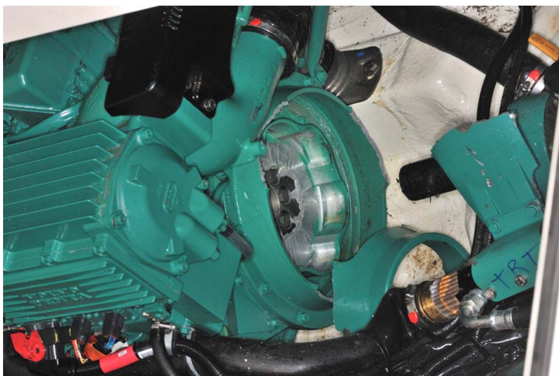
Kuva 22. Murtunut joustokytkin ja akselin rikkoma metallinen kotelo.
