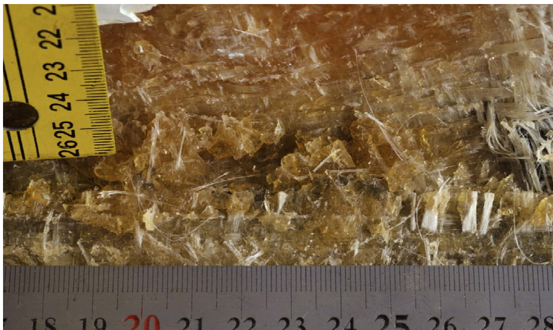
Kuva 19. Peräpeilin alakulman laminaattia veneen oikealta puolelta pohjan ja peräpeilin repeytymisalueelta. Kuvasta näkyy korkea hartsipitoisuus ja kudottujen kankaiden eli Rowing-kerrosten loppuminen välittömästi ennen kulmaa.
