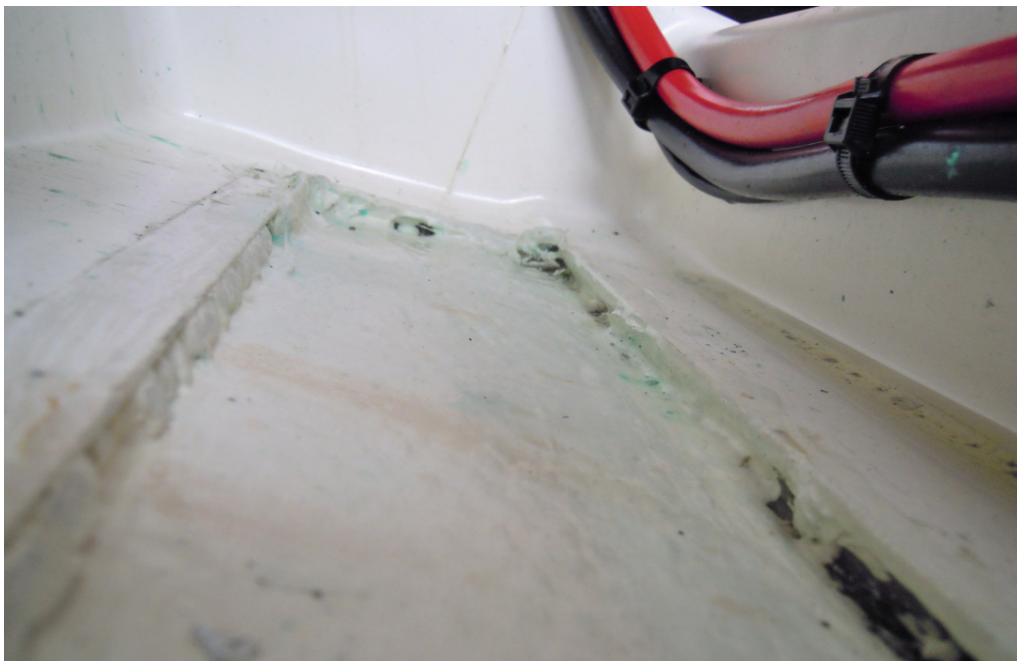
Kuva 30. Pohjapalkit oli saumattu runkoon kiinni liimamassalla. Osien sovitus ei ollut tarkkaa.
