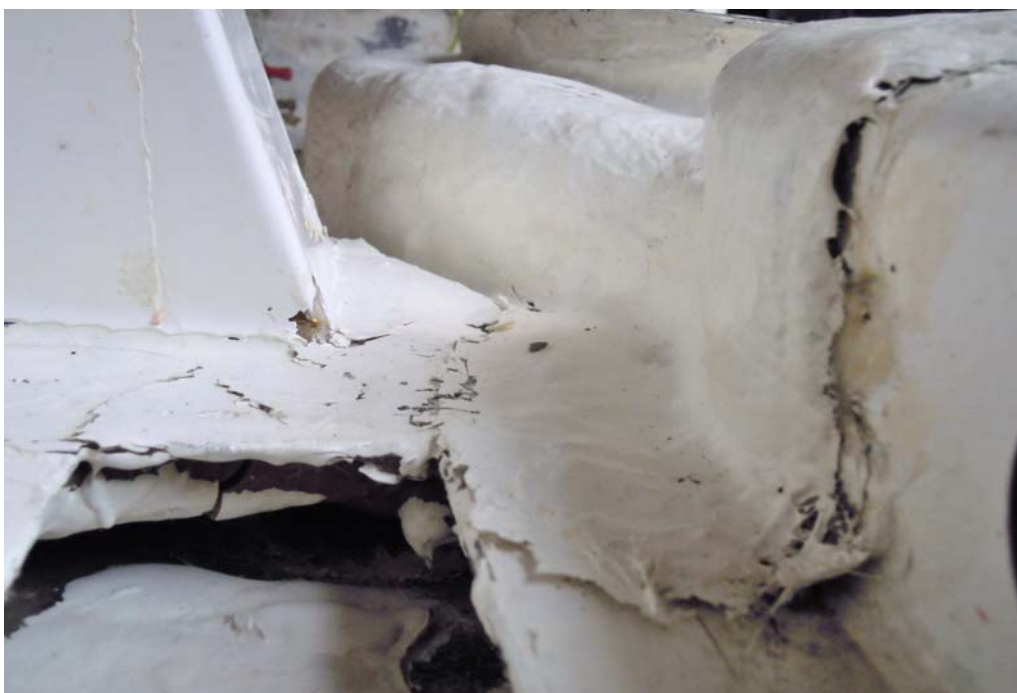
Kuva 31. Pohjan palkit ja niiden saumaus asennusrenkaaseen. Kaikki kuvassa näkyvät raot eivät tutkijoiden näkemyksen mukaan ole syntyneet onnettomuudessa vaan osat ovat olleet irti toisistaan jo ennen onnettomuutta. Tämän osoittaa mm. topcoatin osittainen valuminen liitospintojen alle. Rakenteen lujuus epäilyttää ottaen huomioon, että IPS-vetolaitteessa työntövoima siirtyy runkoon tämän rakenteen välityksellä.
