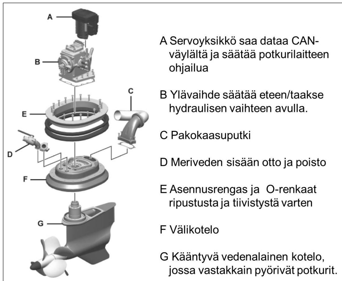
Kuva 2b. Vetolaitteen pääosat eriteltynä.
