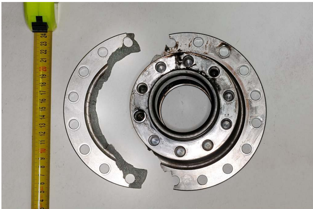
Kuva 7. Kääntöakseli ja sen osittain murtunut laippa.
