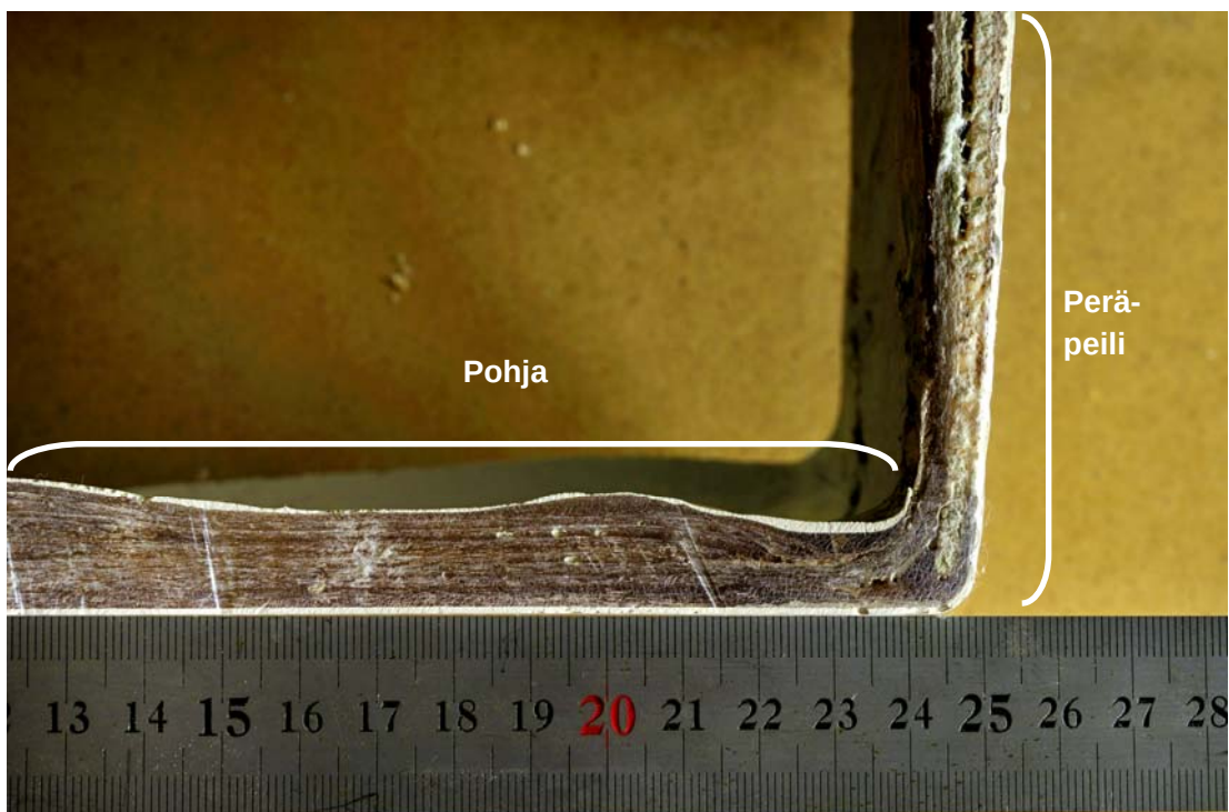
Kuva 14. Kuvassa veneen rungosta – alueelta, missä pohja ja peräpeili yhtyvät – irti-leikattu näytepala. Näytepala leikattiin irti rungon vasemmalta, vahingoittumattomalta puolelta, missä laminaatti ei ole revennyt. Peräpeilin paksuus on alimmillaan kuvan mukaisesti noin 8 mm. Tästä lasikuitulaminaattia on arviolta kaksi 1,5 mm paksuista kerrosta. Laminaattien välissä on mikropalloomassalta vaikuttavaa täyteainetta, jolla rakenteesta muodostuu kerroslevyrakenne.
