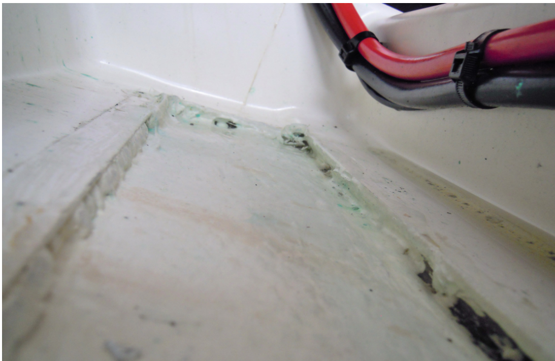
Kuva 26. Pohjapalkit oli saumattu runkoon kiinni liimamassalla. Osien sovitus ei ollut tarkkaa.
