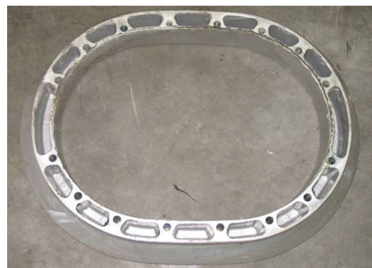
Kuva 10. Asennusrengas ylhäältä (vasemmalla) ja alhaalta (oikealla). Asennusrengas oli vahingoittumaton.
