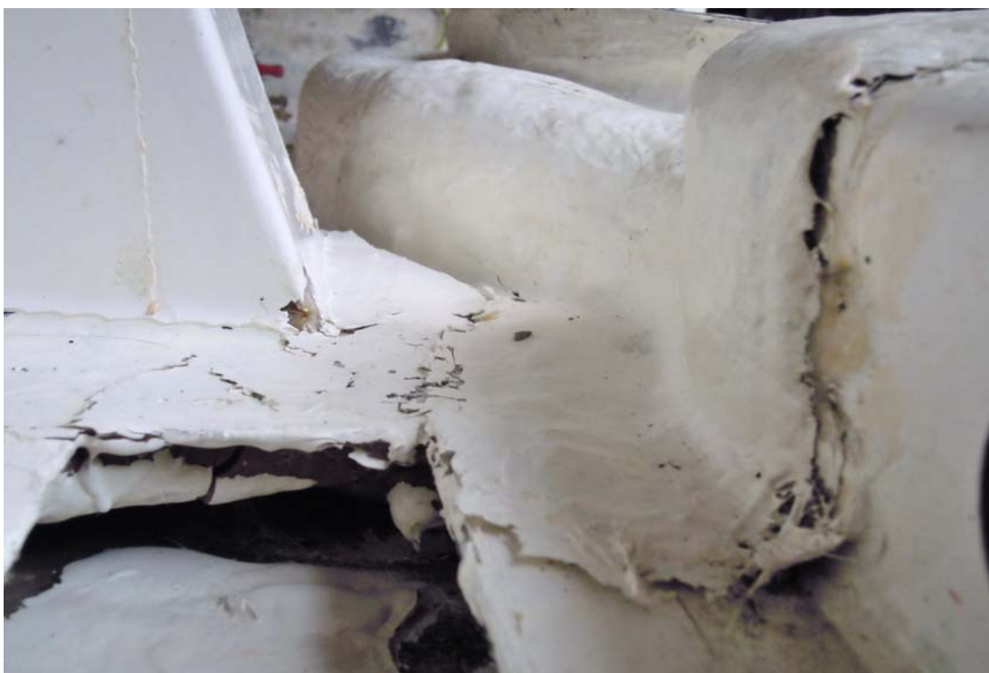
Kuva 27. Pohjan palkit ja niiden saumaus asennusrenkaaseen. Kaikki kuvassa näkyvät raot eivät tutkijoiden näkemyksen mukaan ole syntyneet onnettomuudessa vaan osat ovat olleet irti toisistaan jo ennen onnettomuutta. Tämän osoittaa mm. topcoatien osittainen valuminen liitospintojen alle. Rakenteen lujuus epäilyttää ottaen huomioon, että IPS-vetolaitteessa työntövoima siirtyy runkoon tämän rakenteen välityksellä.
