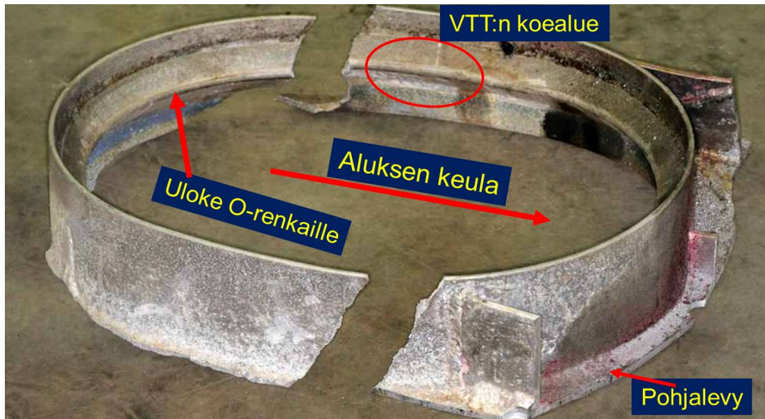
Kuva 8. Alumiinikaulus, VTT:n näytteenottoaikka.
