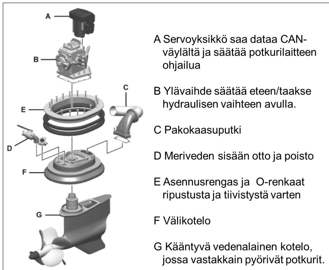
Kuva 2b. Vetolaitteen pääosat eriteltynä.
