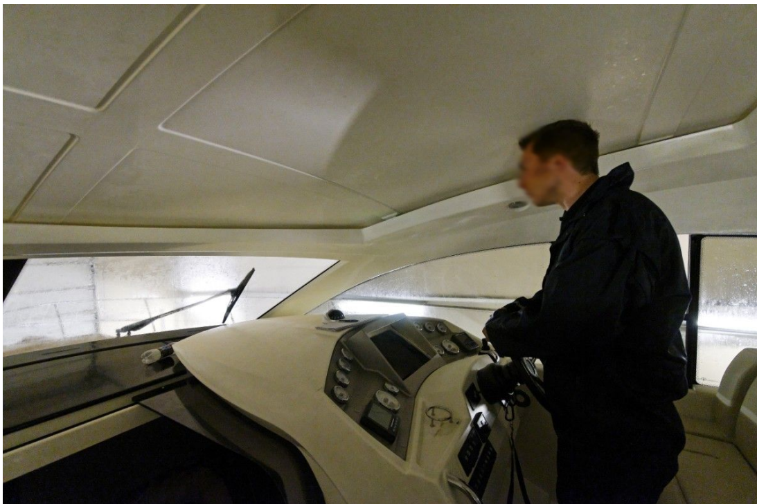
Kuva 13. Kuljettajan paikka seisten kattoluukun ollessa kiinni. Seisten ajettaessa voidaan valita kaksi eri korkeutta missä seistä. Kuva on otettu onnettomuusveneessä korjaushallissa pian veneen nostamisen jälkeen. Kuvan henkilö on onnettomuusveneen päällikköä hieman pitempi.
