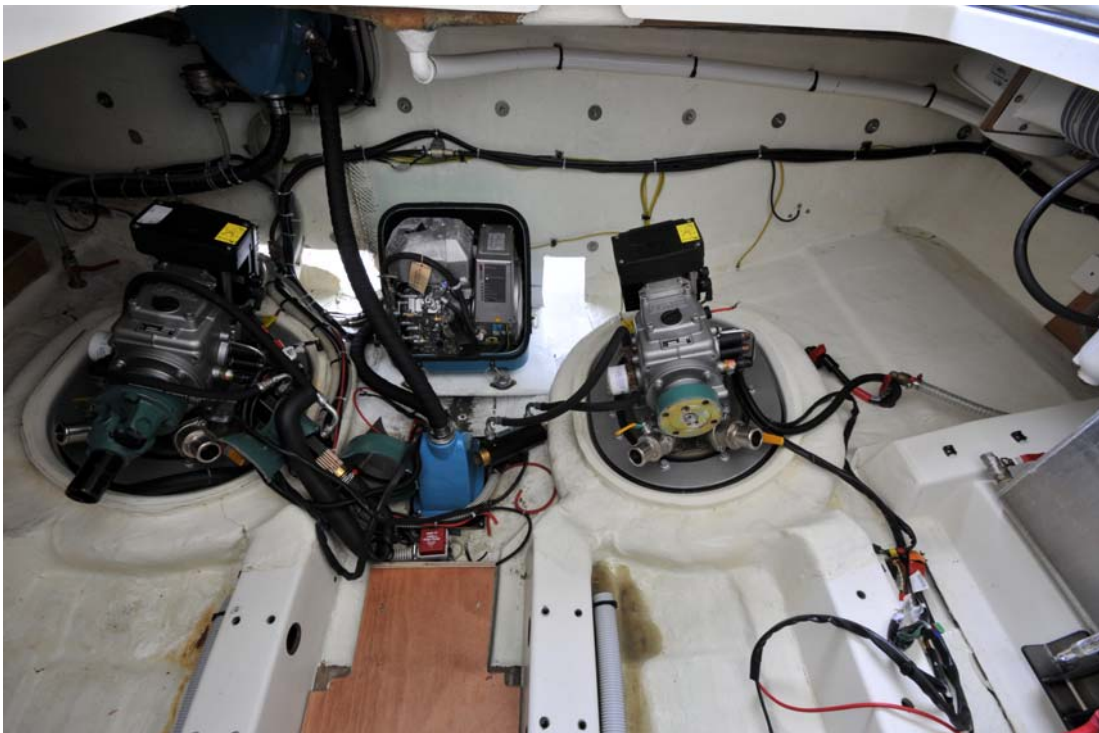
Kuva 3. Pohjapalkiston peräosa on korvattu Volvo Pentan asennusrenkaalla ja sen tukipalkeilla. Kuva on otettu moottoreiden irrotuksen ja konetilan puhdistuksen jälkeen.
