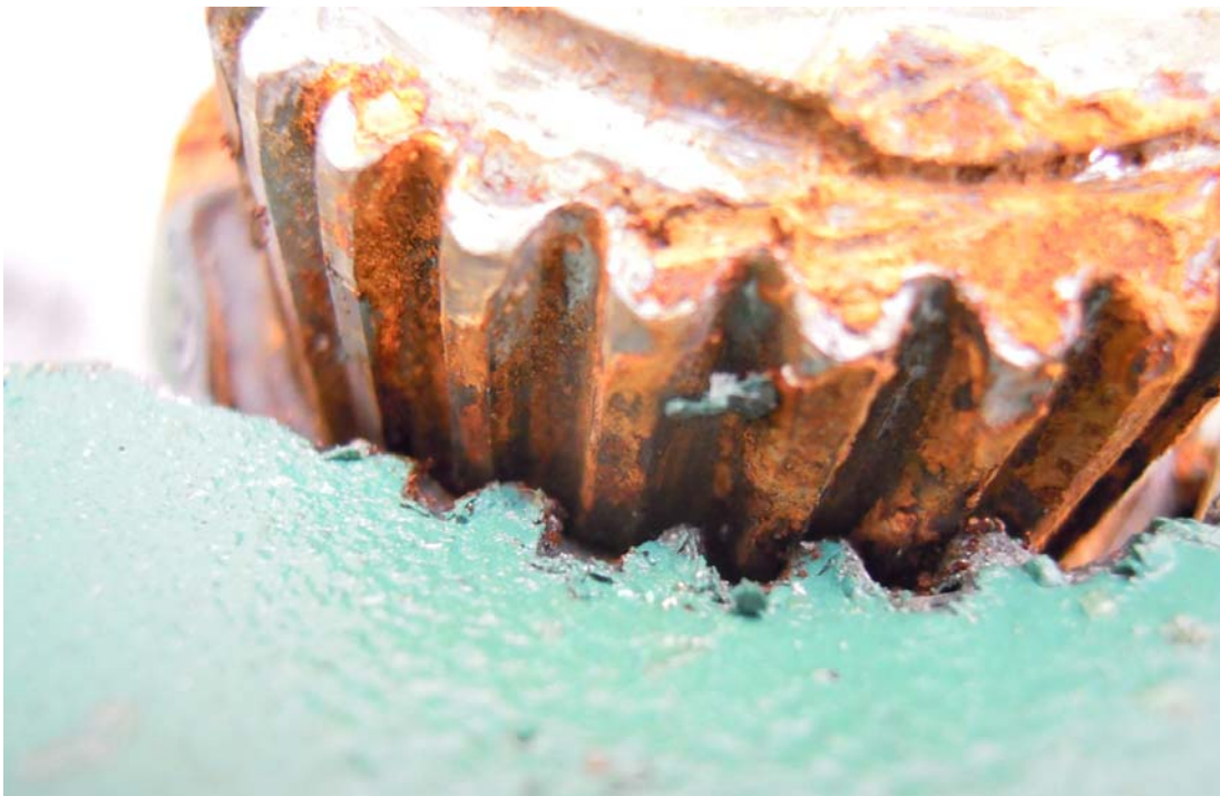
Kuva 20. Vetoakselin hammastus sopii yhteen murtuneen yhdyskotelon jälkien kanssa osoittaen, että akseli on voimalla lyönyt koteloon.
