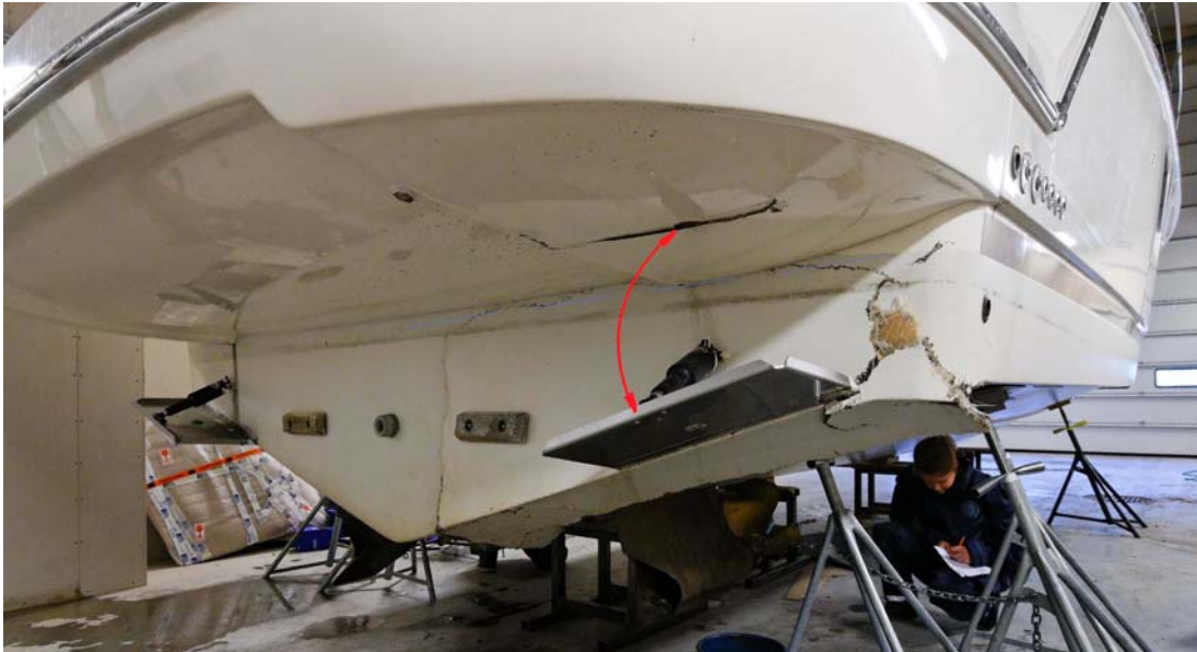
Kuva 17. Veneen peräpeili. Törmäyksessä pohjalevyn ja peräpeilin laminaatit irtosivat toisistaan avaten puolen peräpeilin levyisen raon veneen pohjaan. Tästä raosta ja irti murtuneen IPS-vetolaitteen aukosta vesi täytti konetilan ja koko veneen, jolloin vene upposi. Venettä nostettaessa peräpeili repeytyi enemmän irti ja trimmitaso painoi uimatasoon kuvassa näkyvän halkeaman. Aukko kaapi savea meren pohjasta konetilaan, kun venettä liikutettiin pitkin pohjaa.
