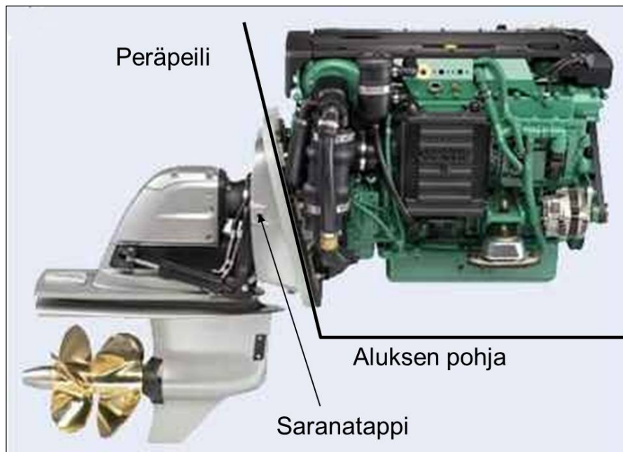
Kuva 3. Venemoottori tavanomaisella perävetolaitteella (Volvo Pentan esitteestä).
