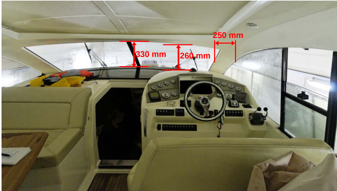
Kuva 11. Yleisnäkymä ohjaamosta kuljettajan paikan takaa. Kuva on otettu onnettomuusveneessä korjaushallissa pian veneen nostamisen jälkeen. Tuulilasin korkeus on 330 mm, ohjauspulpetti rajoittaa näkyvyyttä alaosasta siten, että tehollinen korkeus näkyvyydelle on 260 mm. Sivupilarin leveys on 250 mm.
