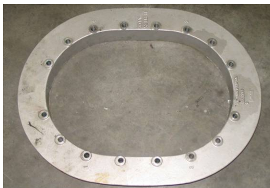
Kuva 10. Asennusrengas ylhäältä (vasemmalla) ja alhaalta (oikealla). Asennusrengas oli vahingoittumaton.
