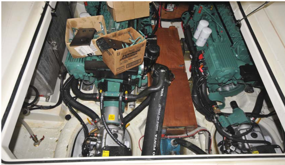
Kuva 6. Onnettomuusveneen konetila puhdistuksen jälkeen. Pahvilaatikoissa on varusteita, jotka liittyvät moottoreiden kuntoon saattamiseen uppoamisen jälkeen eivätkä ne liity onnettomuuteen.
