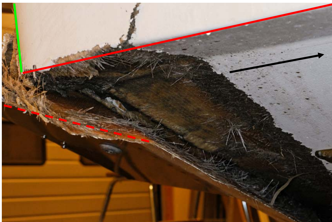
Kuva 16. Repeämä veneen pohjassa. Kuvaan on merkitty vihreällä viivalla veneen peräpeilin ja laidan välinen kulma, punaisella yhtenäisellä viivalla veneen palle, punaisella katkoviivalla peräpeilistä pohjaan ulottuva laminaatti, joka on repeytynyt irti varsinaisesta pohjalaminaatista. Mustalla nuolella on merkitty keulan suunta.
