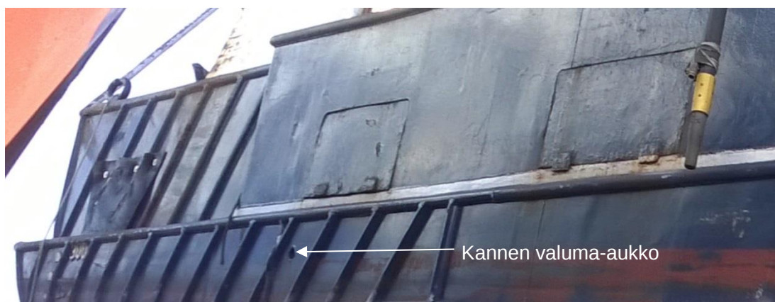
Kuva 18. Bärbelin myrskyluukkuja SB-puolella. (Kuva: Hailiks Oy)
