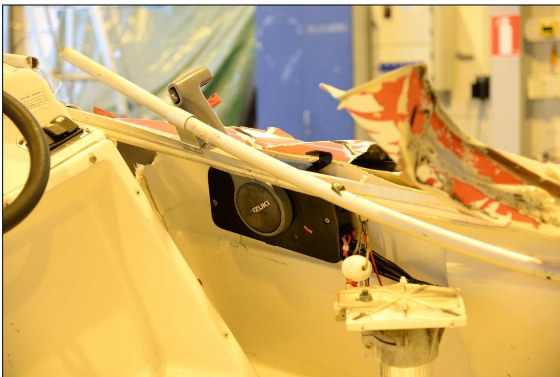
Kuva 6. Pienemmän veneen kuljettajan istuin repeytyi irti törmäyksessä. (Kuva: Rajavartiolaitos)
