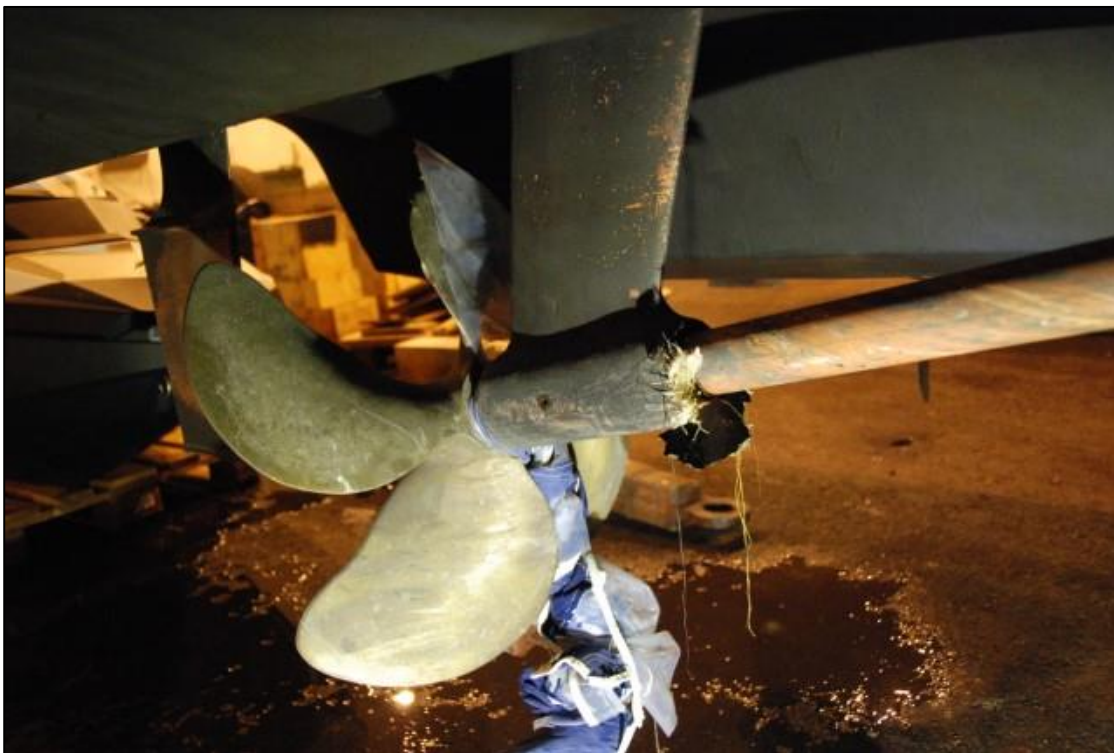
Kuva 5. Isomman veneen potkuriin on tarttunut osa pienemmän veneen kuomua. (Kuva: Rajavartiolaite)
