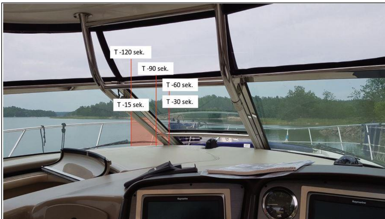
Kuva 12. Katvealueen kuvassa esitetään ikkunapuitteiden ja lepuuttajien vaikutusta tähyttämiseen kahden viimeisen minuutin aikana isomman veneen ajopaikalta. (Kuva: Rajavartiolaitos)
