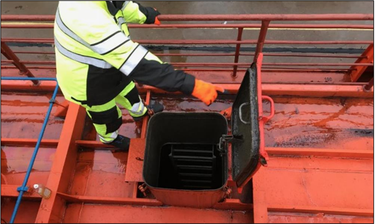
Kuva 3. Tankin 6 miesluukku, josta öljyä tuli kannelle ja edelleen mereen. (Kuva: OTKES)
