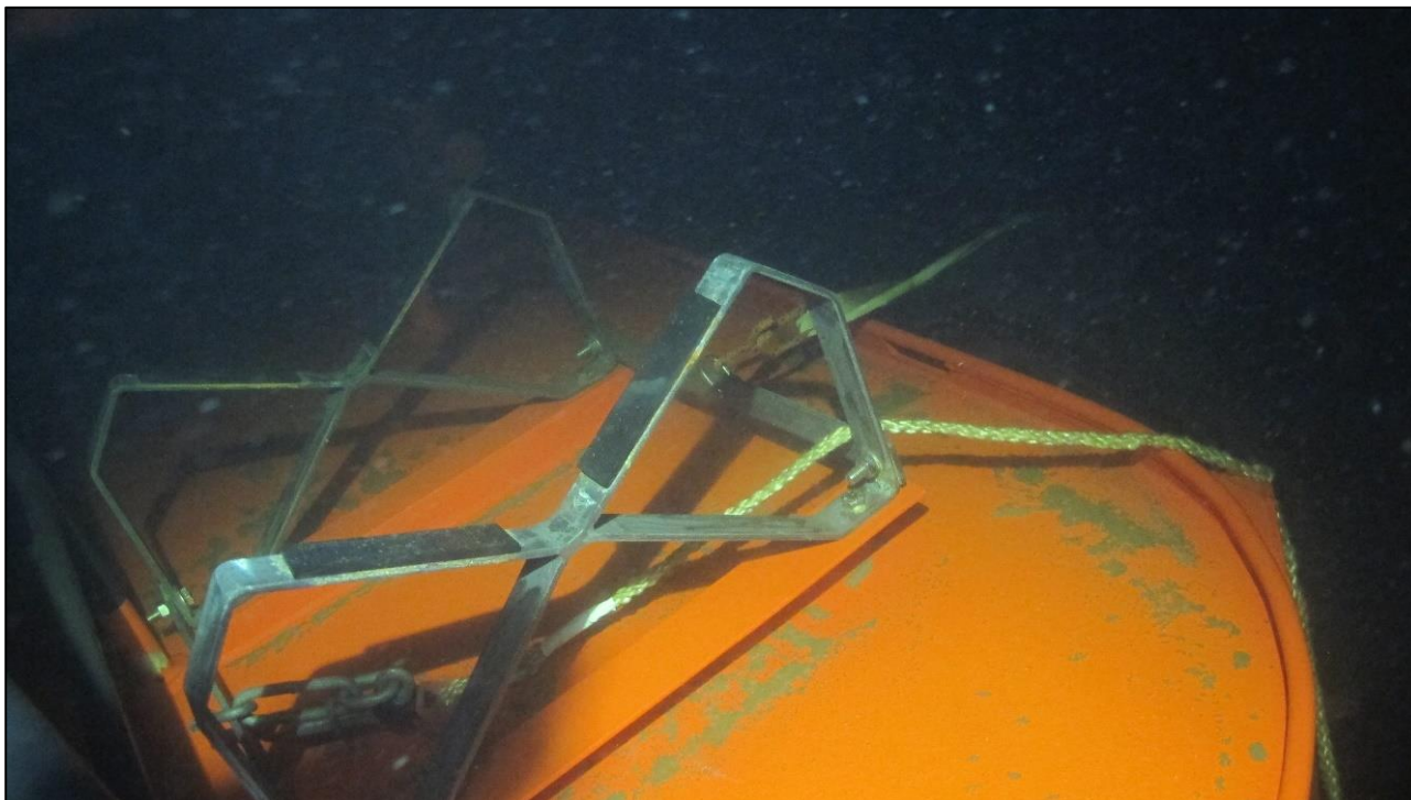
Bild 7. Den tomma ställningen för lotsbåt L-242:s livflotte. (Bild: OTKES)
