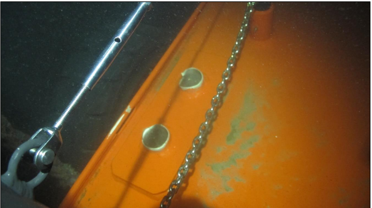
Bild 6. Den bortrivna vänstra akterpollaren på lotsbåt L-242. (Bild: OTKES)
