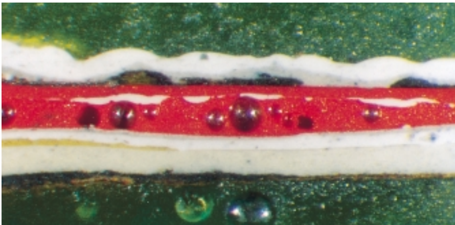
Kuva 12.20 Maalikerrosten poikkileikkaus pohjalukon visiirinpuoleisesta lenkistä otetusta näytteestä.
