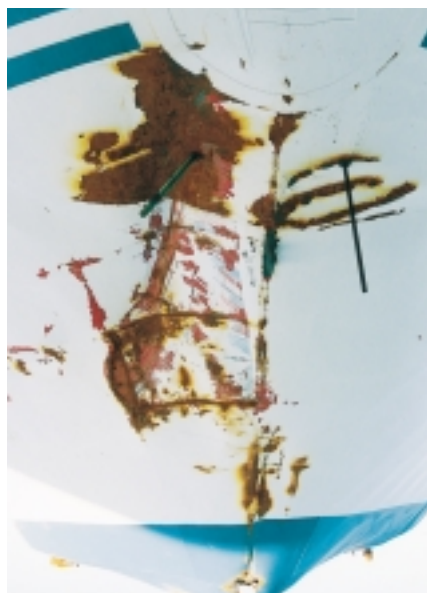
Kuva 8.5 Vaurioita visiirin etupuolella.
