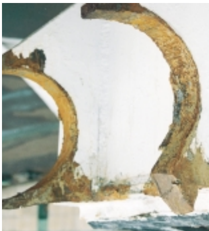
Kuva 8.21 Visiirin vasemmanpuoleisen saranan murtuneet korvakkeet.
