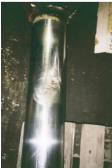
Kuva 8.25 Visiirin vasemmanpuoleisen nostosylinterin männän varren raapaisujälkiä.
