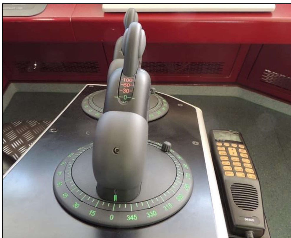
Bild 17. Närbild av roderpropellrarnas styrspakar. På bilden står båda roderpropellrarna midskepps och effektjusteringen på noll. Roderpropellrarna har installerats så att fartygets färdriktning är den riktning som anges av spakarnas övre del. (Bild: OTKES)
