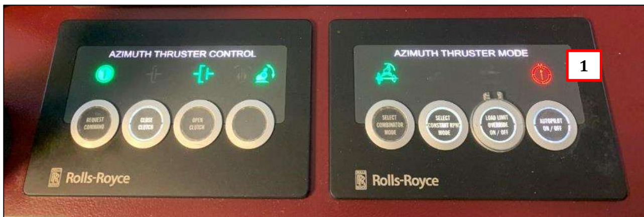
Bild 19. Styrplatsens knapppaneler är i ett simulerat läge där autopiloten har varit aktiverad och styrningen av roderpropellern är defekt. En röd signallampa (1) indikerar ett fel. (Bild: OTKES)
