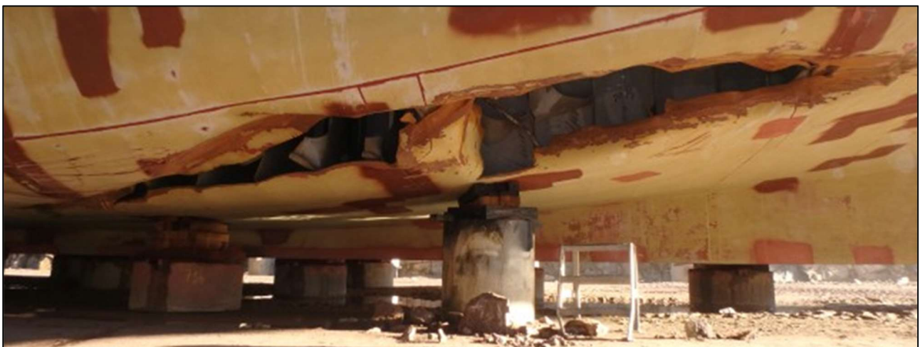
Bild 10. Spricka i fartygets botten som uppstod vid grundstötningen. (Bild: Tykö varv)
