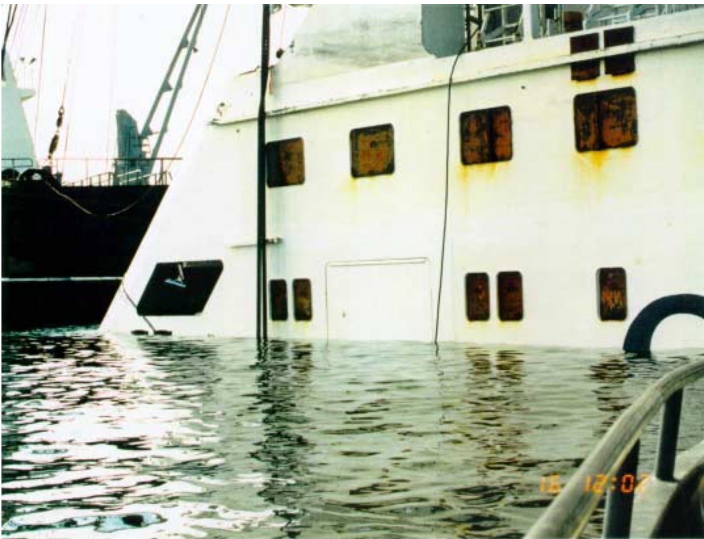
NOBLE LIFTERin kannatinvaijereiden sijainti sekä SALLY ALBATROSSin 3. ja 4. kannen kiinnihitsattuja ikkuna-aukkoja
