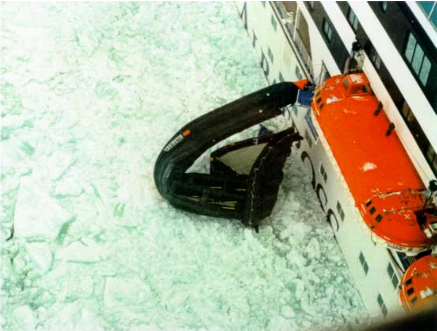
Oikeanpuoleisen liukuradan väärinpäin kääntynyt lauttaosa
