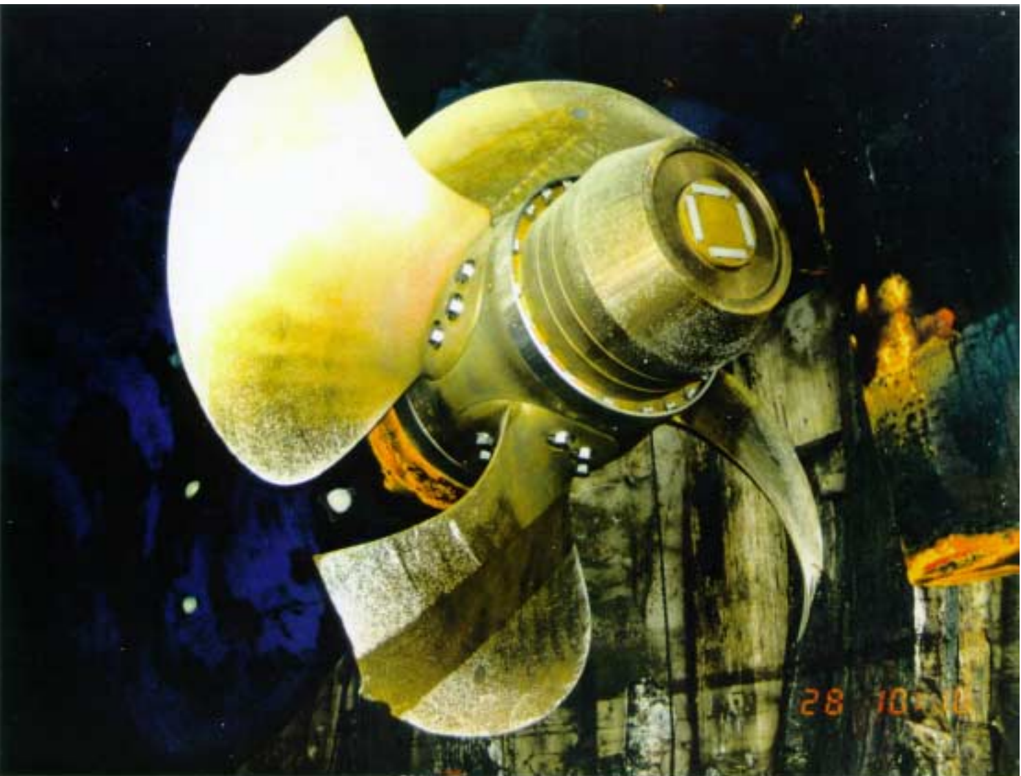
Oikeanpuoleisen potkurin siivekkeiden vaurioita
