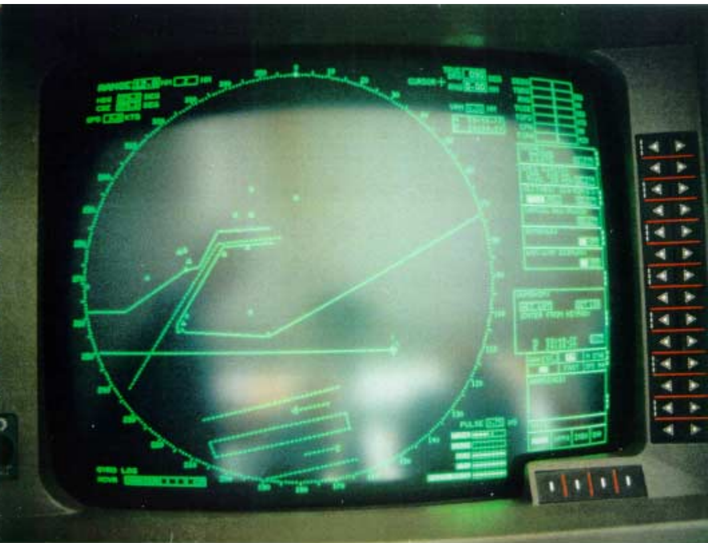
Tutkan kuvaputkella oleva tutkakartta, jolla näkyy Savinin matala ympäristöineen SALLY ALBATROSSin tutkakartan kuva oli samanlainen
