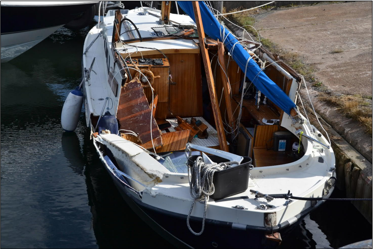
Bild 3. Skadorna på den mindre båten. Kollision bakifrån från vänster. Styrhyttens takkonstruktion har lossnat och finns inte med på bilden. (Bild: OTKES)
