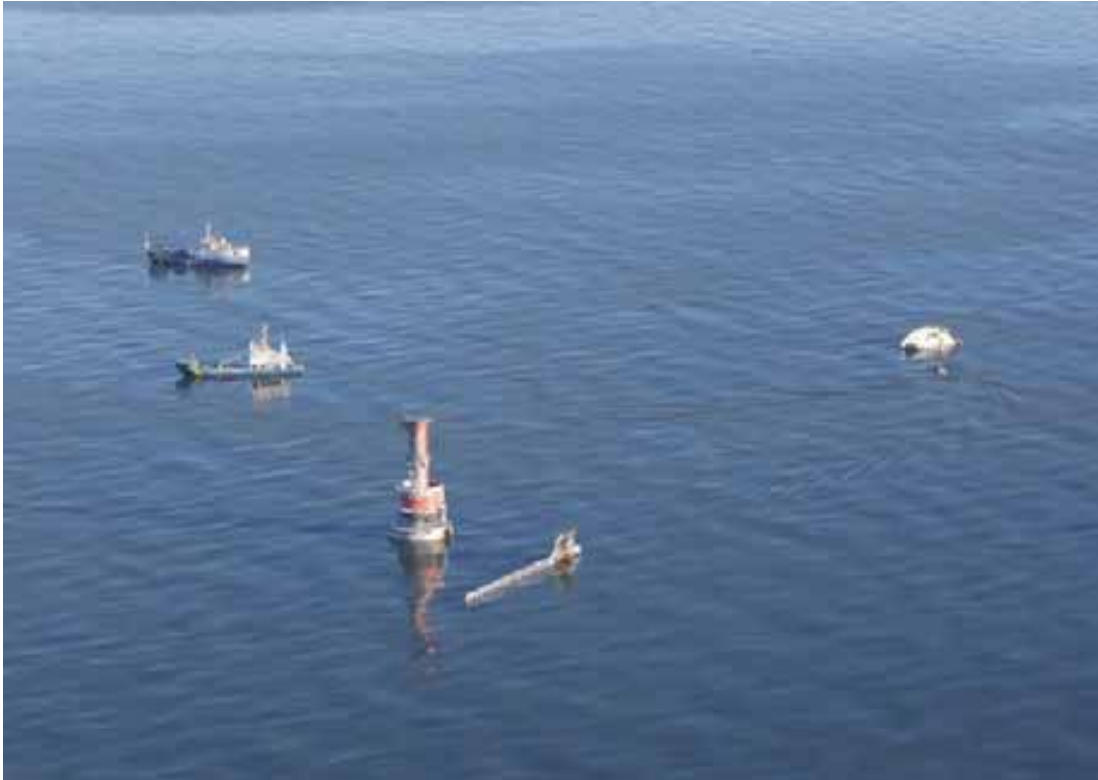
Bild 6. Den förlista fartygskombinationen och Grundkallens fyr. Till höger pråmen BULKs fördäck och bredvid fyren pråmens sidkonstruktioner.
