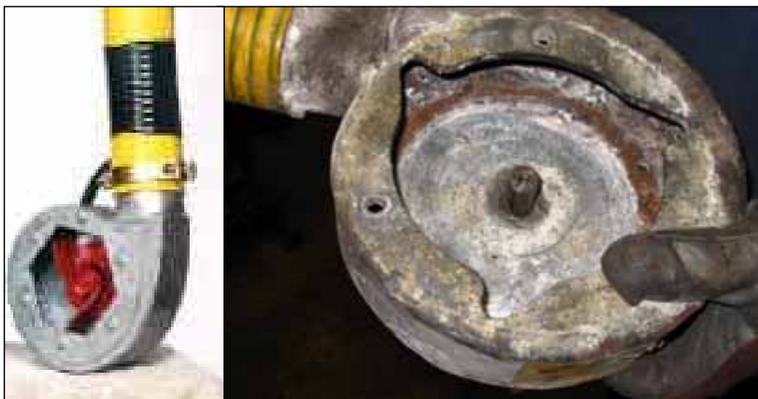
Bild 5. Pumpen Cobra 90. Till vänster broschyrens bild, till höger den demonterade, rengjorda pumpen från det bärgade fartyget med vinghjulet avlägsnat.
