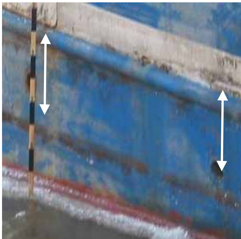
Bild 6. Läget för pumpens avloppsöppning. Öppningens mittpunkt befinner sig cirka 35 cm nedanom däckets kant. Bilden av Beacon Finland Ltd Oy:s mätningar under krängningsprovet 29.12.2004. Däckets kant är på 3,5 meters höjd från baslinjen.
