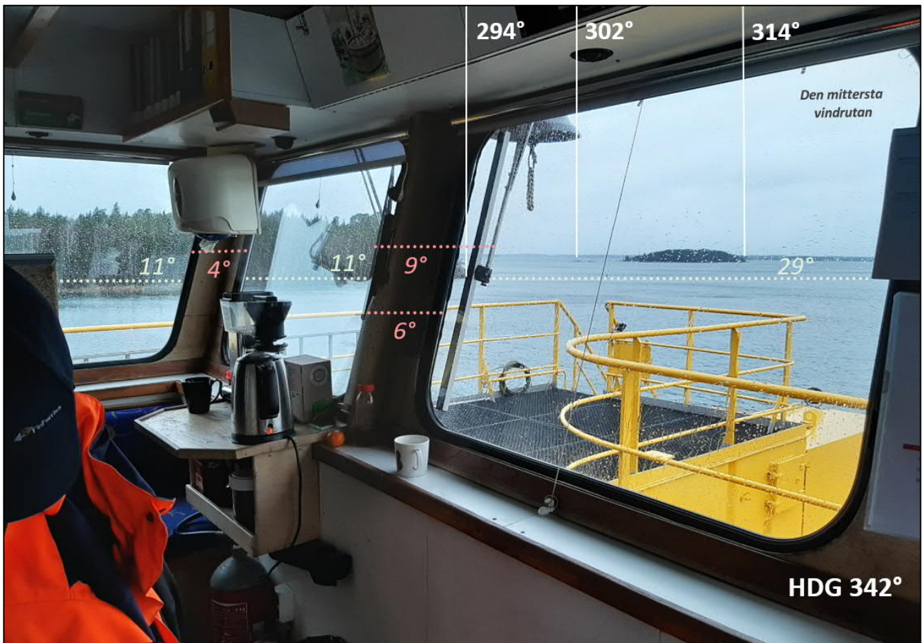
Bild 9. Siktsektorerna som öppnar sig framåt till vänster från Mergus styrhytt. Sektorn som öppnas genom den mittersta vindrutan är 29° från kanten av pappren till vindrutetorkaren och den vänstra mittpelaren förorsakar ett 9° stort område med skymd sikt tillsammans med vindrutetorkarna. Bilden har tagits vid bryggan i Galtby så att kameran har placerats i ögonhöjd för en medellång person som sitter vid den främre styrplatsen. Bilden har fixerats i terrängen med bäringar: den mittersta vid Kuggholmens nedre linjetavla, den vänstra vid Träsknäs norra spets och den högra vid Stora Kuggholms nordöstra spets. Avståndet till holmen är cirka 0,7 M och holmens bredd är cirka 260 meter. Trädtopparnas höjd motsvarar ungefär Finnskans genomsnittliga höjd. (Bild: OTKES)
