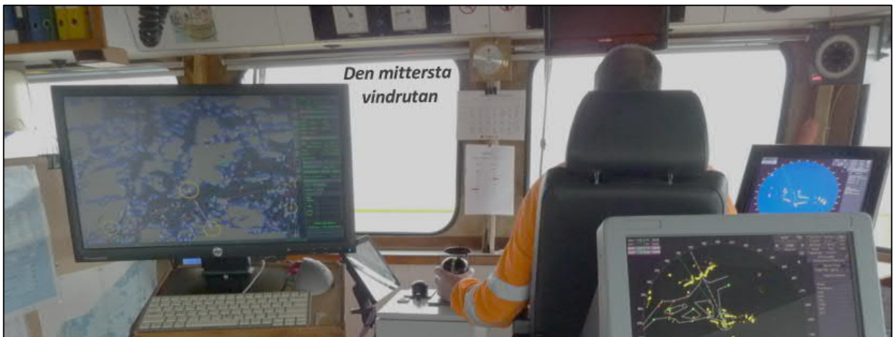
Bild 8. Områden med skyddad sikt i Mergus styrhytt fotograferade bredvid den bakre styrplatsen. Rorsmannen sitter vid den främre styrplatsen, där den manuellt integrerade styrspaken (handroder & effektjustering) används med vänster hand. Till vänster bredvid spaken finns autopilotens pekskärm. Personen på bilden har ingen anknytning till den utredda händelsen. (Bild: OTKES)
