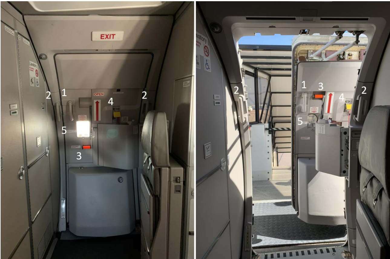
Kuva 2. A320-lentokoneen matkustamon vasen takaovi suljettuna ja osittain avattuna. Oven osat merkitty kuvaan numeroilla seuraavasti: 1. Oven apukahva, 2. Oven karmin apukahvat, 3. Oven avauskahva, 4. Hätäliukumäen varmistuskahva, 5. Kurkistusikkuna. (Kuva: OTKES)
