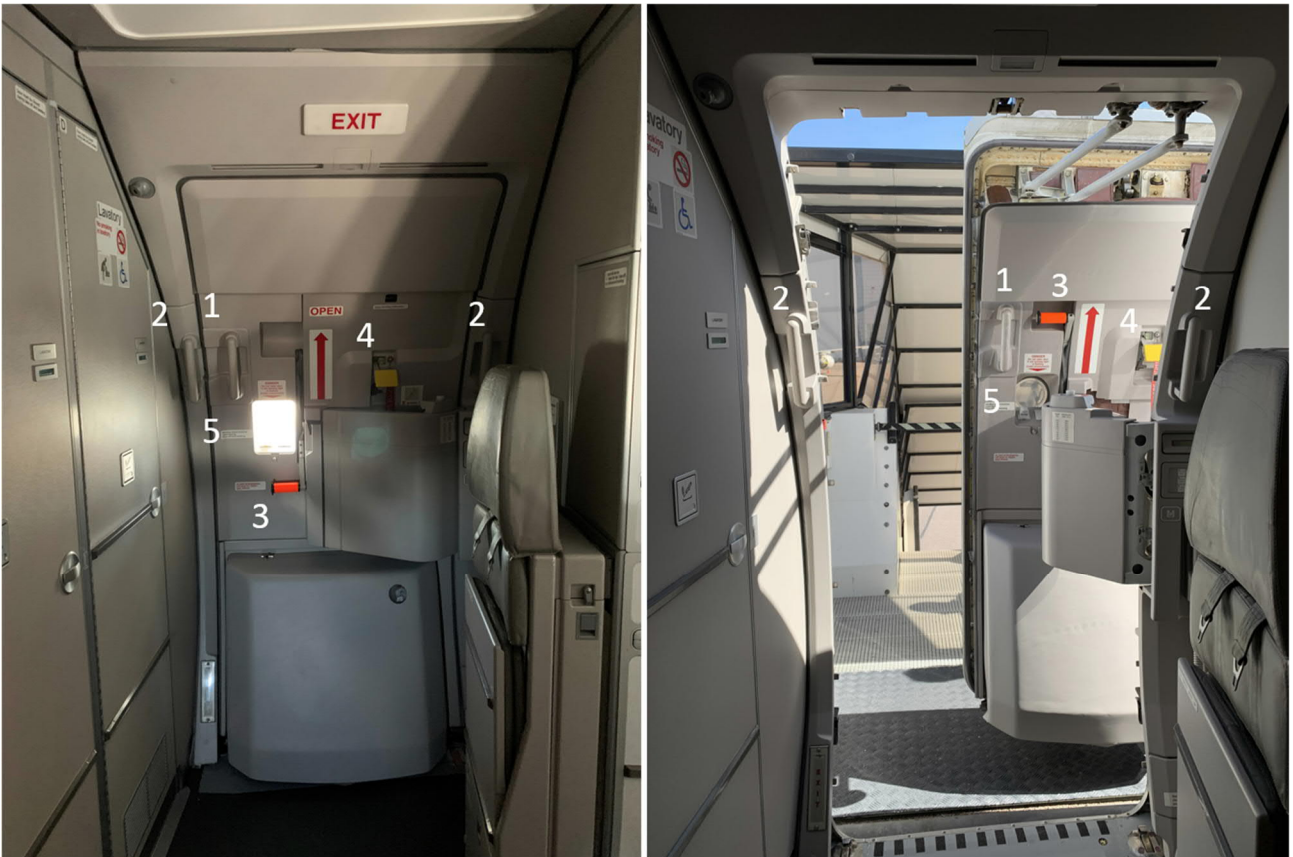
Kuva 2. A320-lentokoneen matkustamon vasen takaovi suljettuna ja osittain avattuna. Oven osat merkitty kuvaan numeroilla seuraavasti: 1. Oven apukahva, 2. Oven karmin apukahvat, 3. Oven avauskahva, 4. Hätáliukumäen varmistuskahva, 5. Kurkistusikkuna. (Kuva: OTKES)
