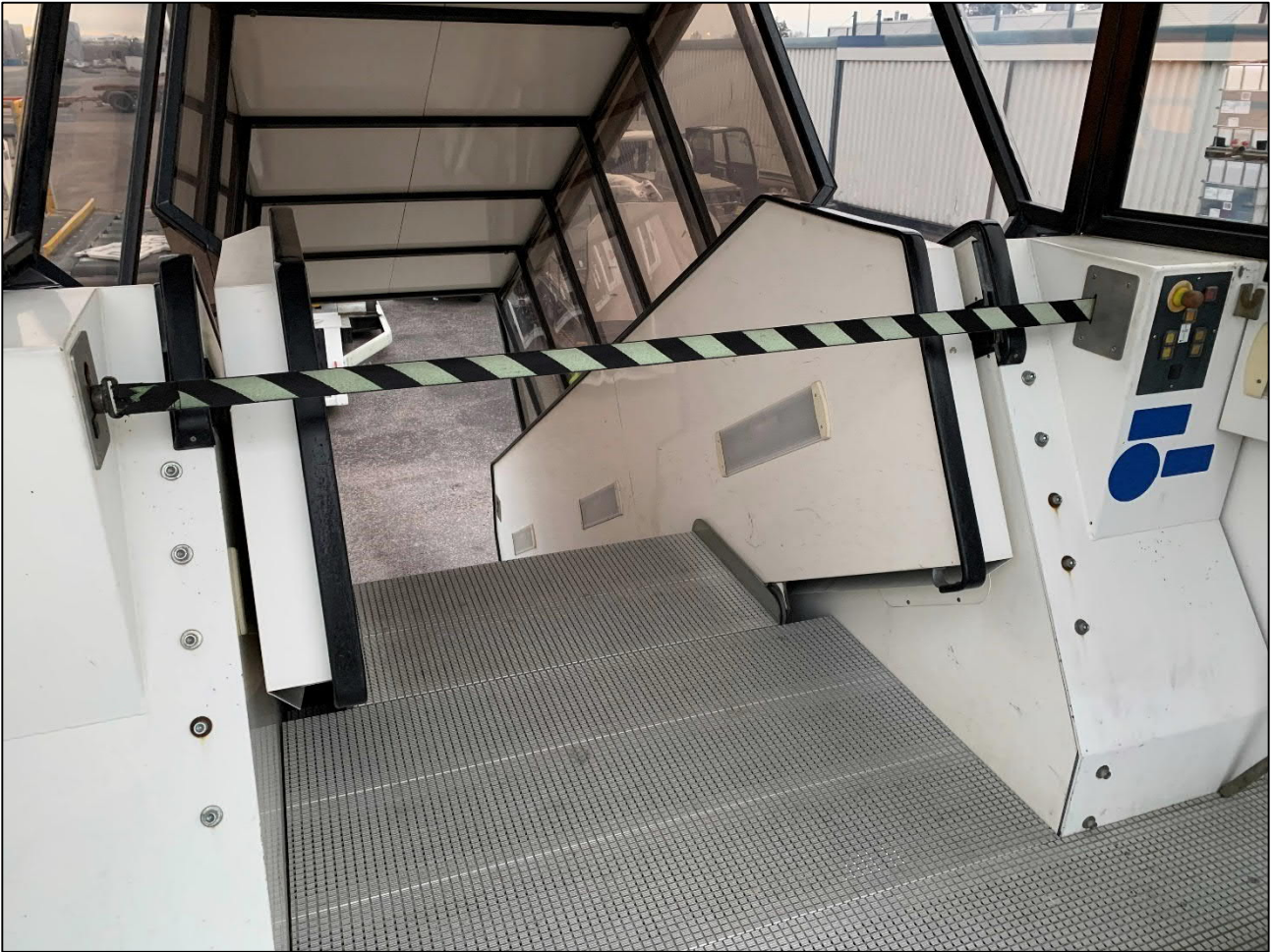
Kuva 4. Porrasauton ylätasanne ja turvahihna. Turvahihnan oikeassa päädyssä on ylätasanteen ohjauspaneeli ja hätä-seis -painike. (Kuva: OTKES)
