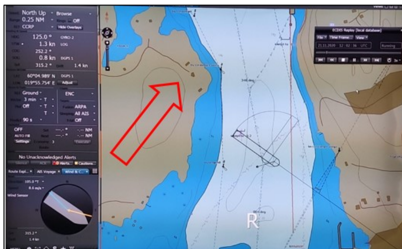
Kuva 6. 12:02:36 Tuuli puhaltaa suurin piirtein M/S Viking Gracen oikealta puolelta. Tuulen nopeus 5,6 m/s ja suunta 218° (aluksen tuulimittarin mahdollinen katvealue?).
