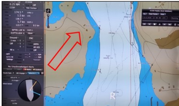
Kuva 11. 12:06:46 Perä osuu rantaan. Heti tämän jälkeen tuulen nopeus nousee 26 metriin sekunnissa.
