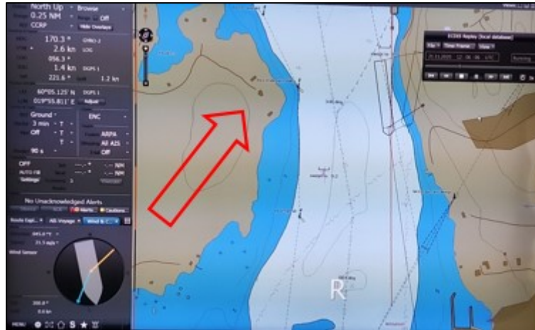
Kuva 10. 12:06:06 Tässä vaiheessa alus alkaa liikkua eteenpäin (1,2 solmua) mutta ajautuu paapuurin suuntaan. Ennustava muuttuja ja vektori näkyvät maalla. Tuulen nopeus 24 m/s ja suunta 220°.
