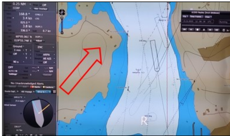
Kuva 8. 12:04:36 Tässä vaiheessa ohjaus on vielä normaali, sivupoikkeama on 0,7° ja tuuli voimistuu. Vauhti taaksepäin on yhä 3,4 solmua. Tuulen nopeus 24 m/s ja suunta 220°.
