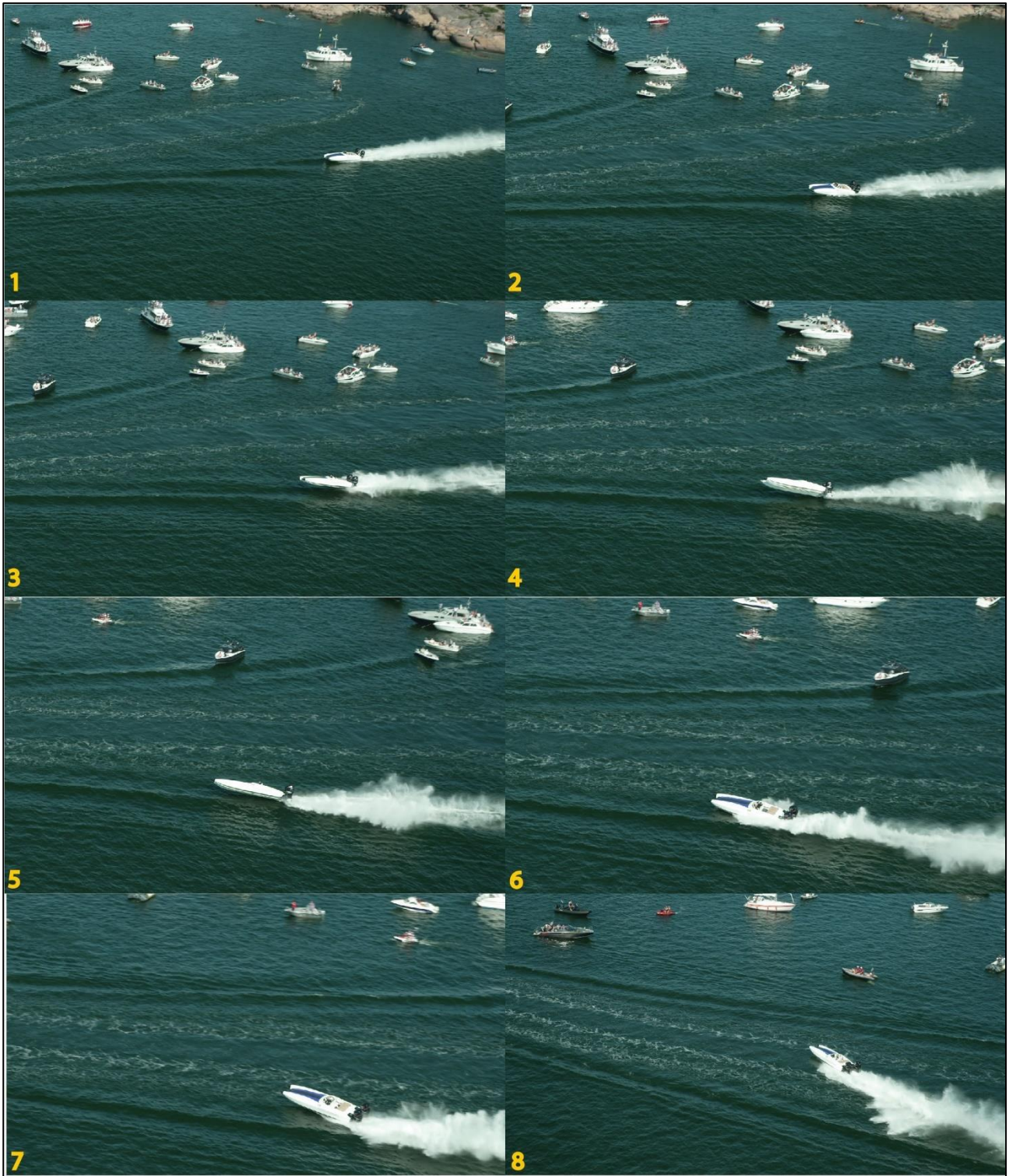
Kuva 3. Kuvasarja katamaraaniveneen osumisesta aaltoihin: 1. Vene osuu loivassa kulmassa loitto-neviin aaltoihin. 2–4. Vene hyppää aallosta vasen ponttoonin ensin ja kallistuu ilmalennon aikana oikealle. 5–6. Vene laskeutuu oikealle ponttoonille ja suoristuessaan vasen ponttoonin osuu toisen aallon reunaan. Vene muuttaa kurssiaan oikealle. 6–7. Nopean suoristumisen ja kurssimuutoksen seurauksena kuljettaja sinkoutuu matkustajan istuimelle. Kuva 8. Vene jatkaa kohti yleisöveneit. (Kuvat: Tactical Vision Unit Oy, merkinnät OTKES).
