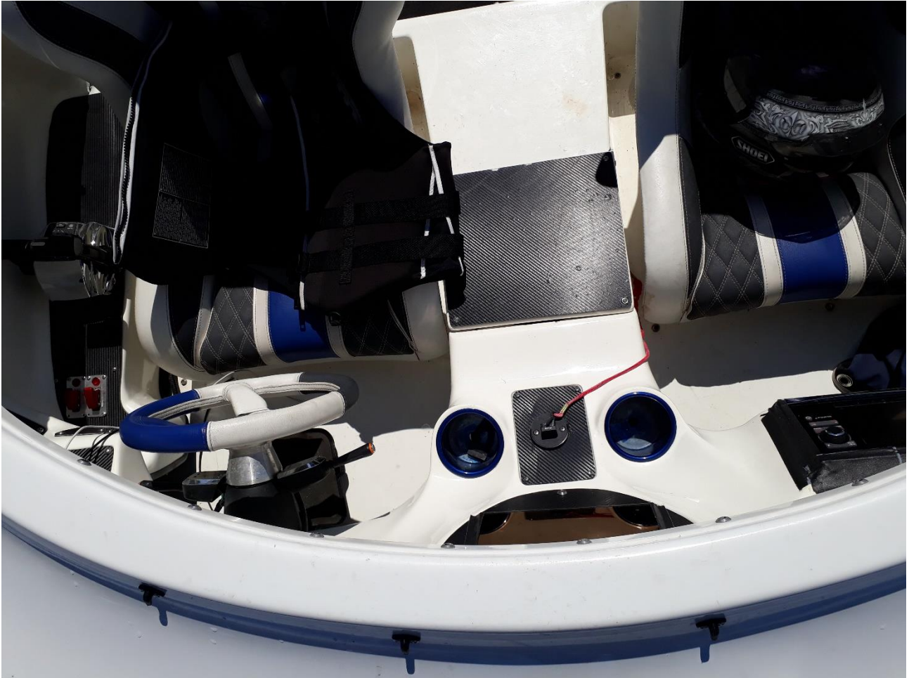
Kuva 6. Kuva onnettomuusveneen ohjaamosta. Punainen hätäpysäytysnaru näkyy kuvan keskellä ja käsikaasut kuvan vasemmassa laidassa. (Kuva: Poliisi)
