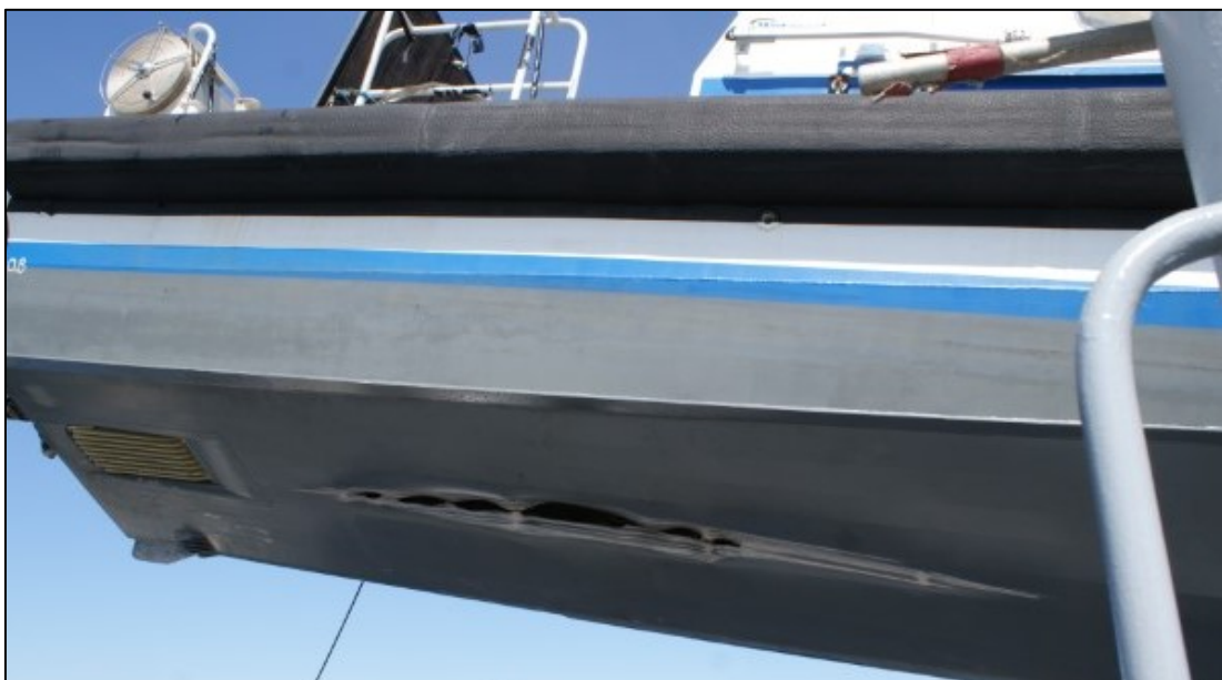
Kuva 4. PV 83:n pohjan vaurio ja reikä. (Kuva: Otkes)
