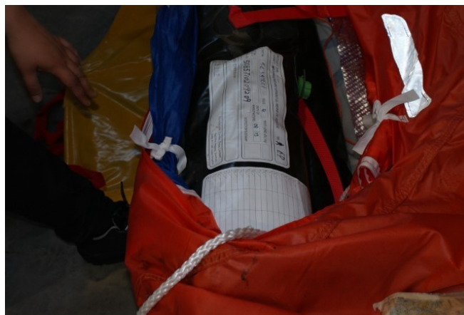
Kuva 16. Pelastuslautan tyyppikilpi ja huoltoseuranta. (Kuva: Otkes)
