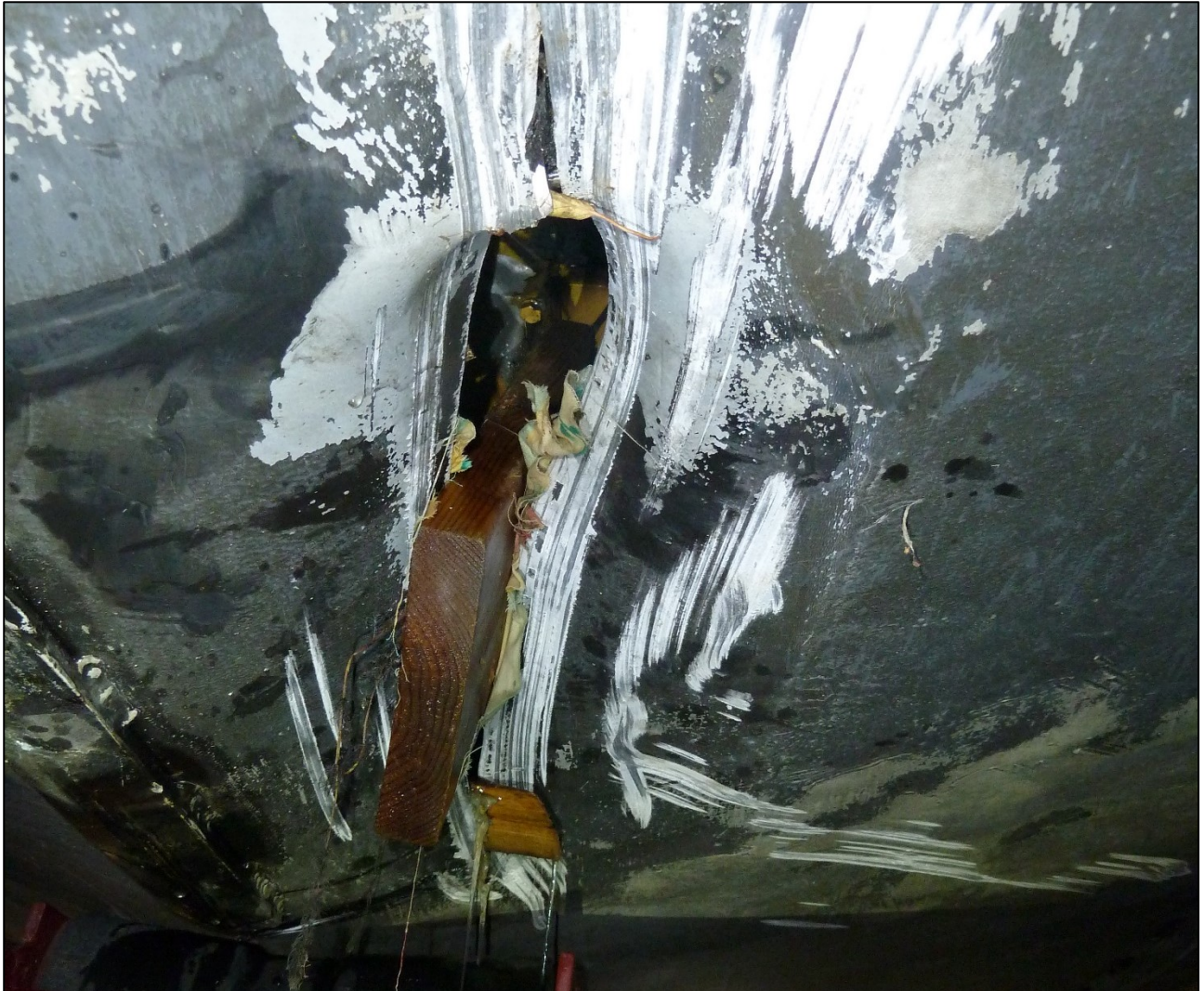
Kuva 10. Veneen pohjaan pohjakosketuksessa tullut 0,6 m pitkä ja leveimmillään 7 cm leveä repeämä ja sitä edeltävät hankausjäljet. Reikää on tilkitty puupaloilla ja kankailla hylyn nostoa varten. (Kuva: OTKES)
