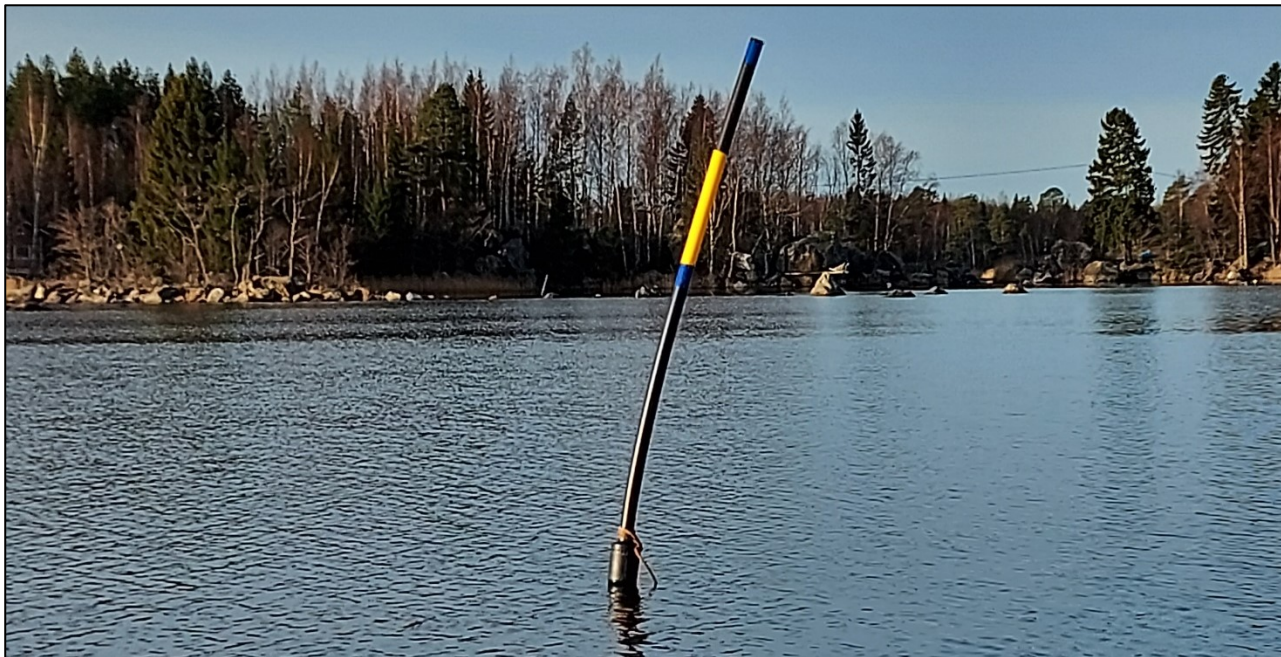
Kuva 11. Esimerkki väylän merkintään käytetyistä kardinaaliviitoista. Kuvassa itäviitta, jonka vene sivuutti länsipuolelta ja sai pohjakosketuksen. (Kuva: OTKES)
