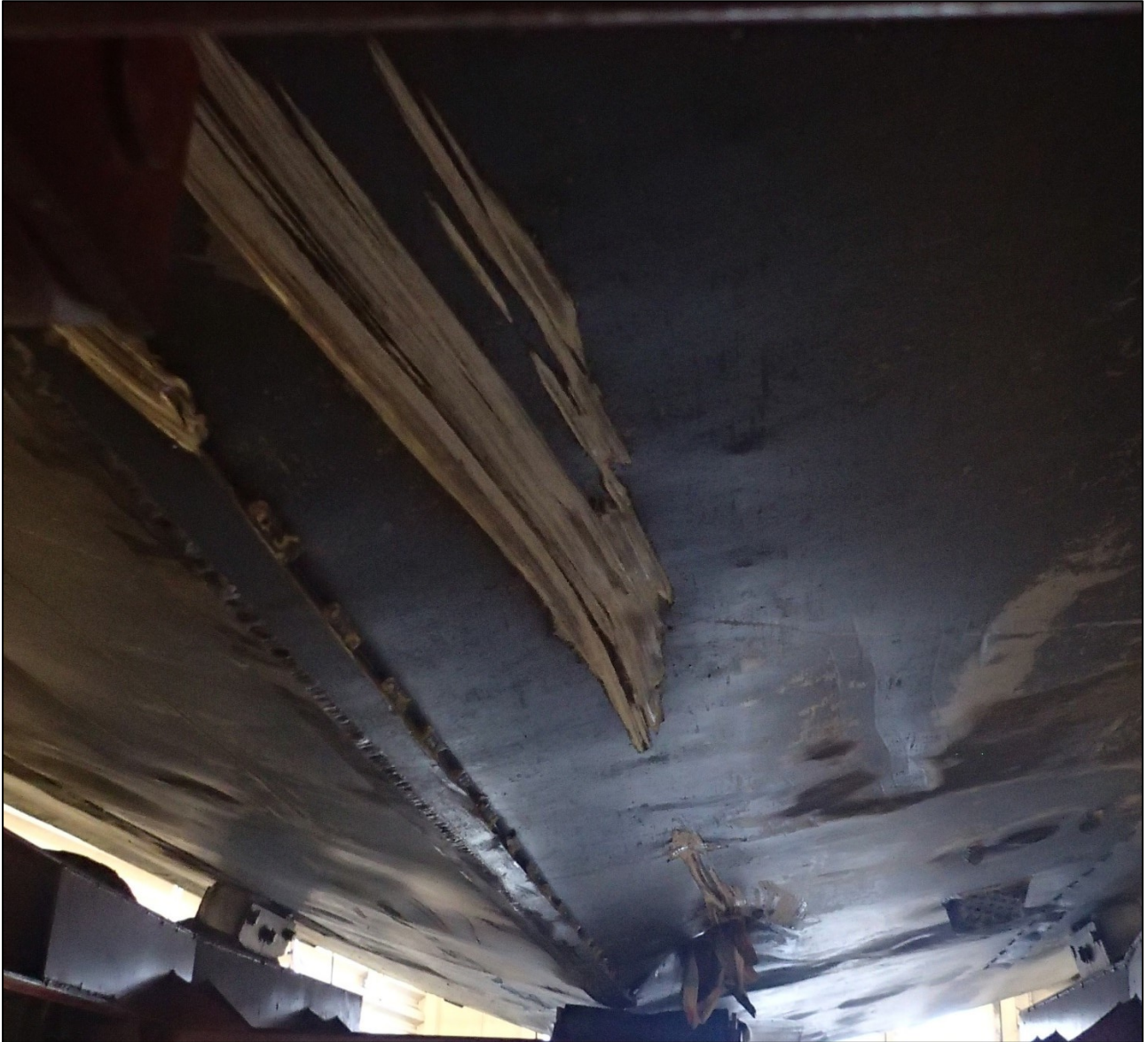
Kuva 9. Pohjakosketusten jäljet veneen pohjassa keskilinjän vasemmalla puolella. Ensimmäinen pohjakosketus on osunut osin kölin listaan, eikä ole aiheuttanut vuotoa. Toinen pohjakosketus on osunut 0,2 m veneen keskilinjän vasemmalle puolelle ja lävistänyt pohjan. Kuva veneen keulasta perään päin. (Kuva: OTKES)
