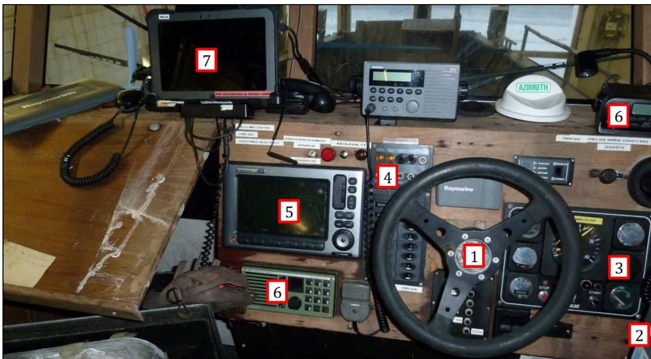
Kuva 8. Veneen kojetaulu: (1) ruori, (2) tehonsäätökahvat (kuvan ulkopuolella), (3) moottorinvalvontamittarit, (4) katkaisinpaneelit mm. valot ja pilssipumput, (5) tutka/kaikuluotain/karttaplotteri, (6) meri-VHF -radiopuhelimet, (7) PEKE-päätelaite. (Kuva: OTKES)
