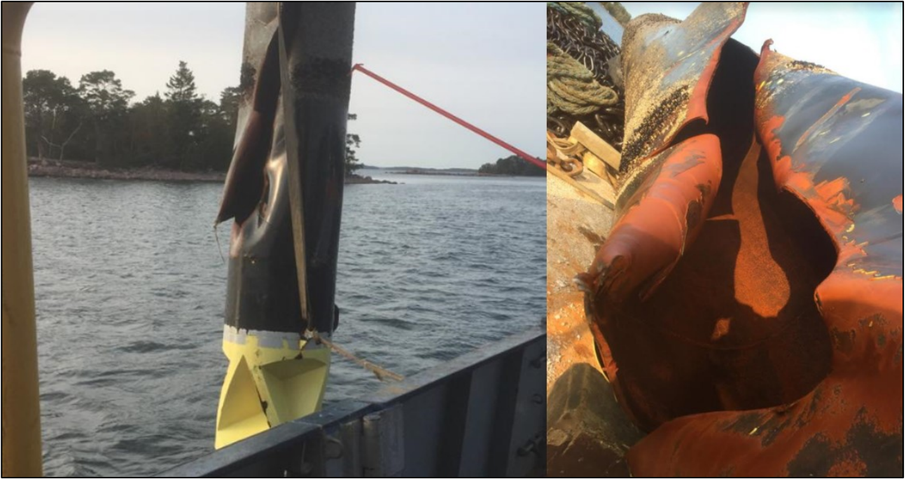
Kuva 25. Isbojen vid Julgrund som hamnade under Amorella skadades i samband med olyckan. (Bild: OTKES)
