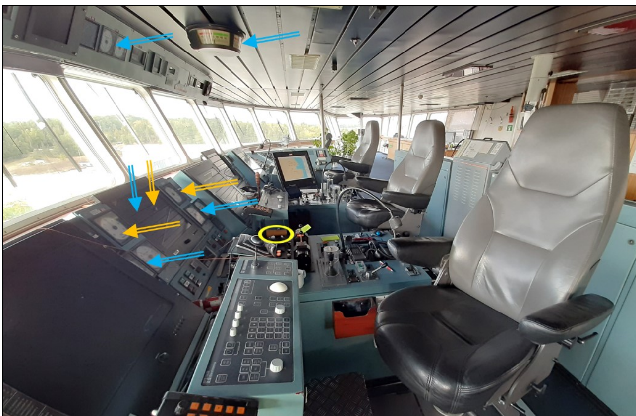
Kuva 9. Styrplatserna på Amorella. Det finns flera rodervinkelmätare (blåa pilar) och girhastighetsmätare (orange) och deras värden kan också följas på Conning-skärmen (lodräta pilar). Dessutom visas girhastigheten på både ECDIS- och radarskärmarna. Bladvinkelmätarna och signallamporna för larmen som gäller de justerbara propellrarnas funktion har placerats i mittkonsolens plana yta vid den gula ellipsen. När olyckan inträffade arbetade linjelotsen vid styrplatsen närmast kameran och vaktstyrmannen vid den mittersta styrplatsen. (Bild: OTKES)
