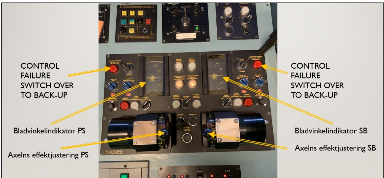
Kuva 8. Brytarna till systemet för justering av propellrarnas bladvinklar och reservsystemet i mittkonsolen samt den röda signallampan för felsituationer Control Failure. (Bild: OTKES)
