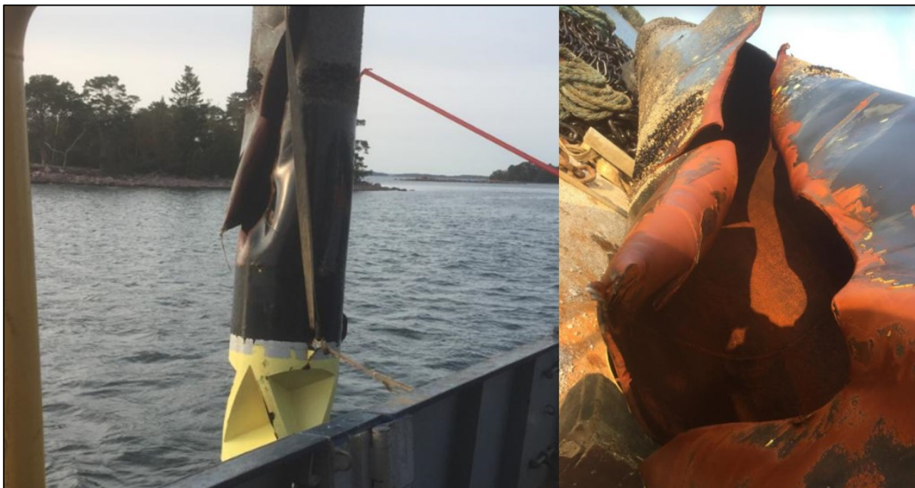
Kuva 25. Amorellan alle jäänyt Julgrundin jääpoiju vaurioitui onnettomuudessa. (Kuva: OTKES)
