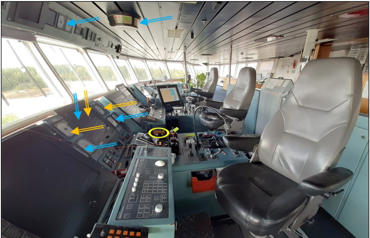
Kuva 9. Amorellan ohjailupaikat. Peräsinkulmamittareita (siniset nuolet) ja kääntymisnopeusmittareita (oranssi) on useita ja arvoja voi seurata myös Conning-näytöltä (pystynuolet). Lisäksi kääntymisnopeus on nähtävissä sekä ECDIS:n että tutkan näytöiltä. Lapakulmamittarit ja säätölapapotkureiden toimintaa koskevat hälytysvalot on sijoitettu keskikonsolin tasopintaan keltaisen ellipsin kohdalle. Onnettomuuden tapahtuessa linjaluotsi työskenteli lähinnä kameraa olevassa ohjauspisteessä ja vahtiperämies keskimmaisessa. (Kuva: OTKES)
