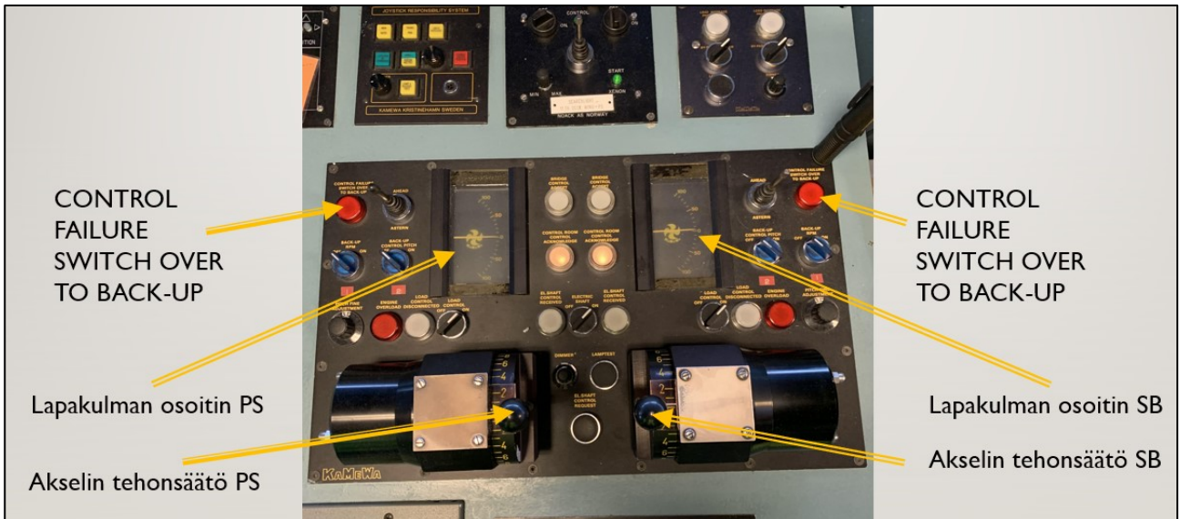
Kuva 8. Keskikonsolissa olevat potkurien lapakulmien säätöjärjestelmän ja varajärjestelmän käyttökytkimet sekä vikatilanteen punainen merkkivalo Control Failure. (Kuva: OTKES)
