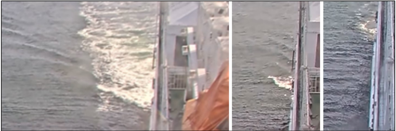
Kuva 22. Oikean potkuriakselin jarruttava vaikutus näkyy aluksen vanavedessä selvästi. Vasemmanpuoleinen pysäytyskuva on ajalta, jolloin peruutusteho oli suurimmillaan ja alus oikealle kääntyvässä liikkeessä. Keskimmäisessä kuvassa lapakulmat ovat vielä noin 20 % peruutuksella, mutta potkuriakselin kierrosluku on noussut, jolloin akseli jarruttaa uudelleen (noin kello 12.35.30). Oikeassa kuvassa näkyy tehopyynnön mukainen lyhyt jarrutus, kun alusta ohjattiin toisen poijuportin läpi. (Kuva: Viking Line Oyj)
