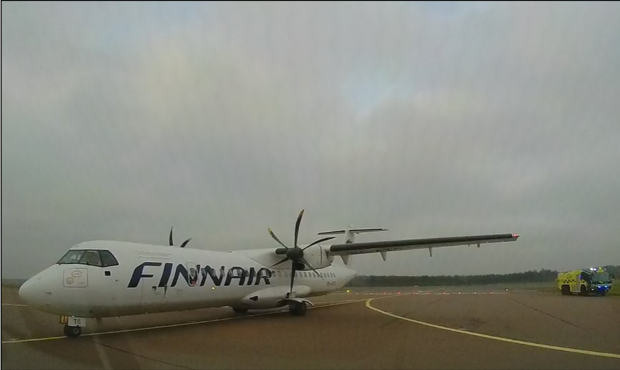
Kuva 1. OH-ATG rullaustiellä Y lähdössä rullaamaan kohti seisontapaikkaa 8. Kuvassa näkyvät avattu kommunikointiluukku takaikkunan alapuolella sekä rahtioven vedettynä oleva avauskahva ja sen viereinen avauskahvan vetämisen kanssa samanaikaisesti aukeava paineentasausluukku avoimena. (Kuva: Finavia Oyj).
