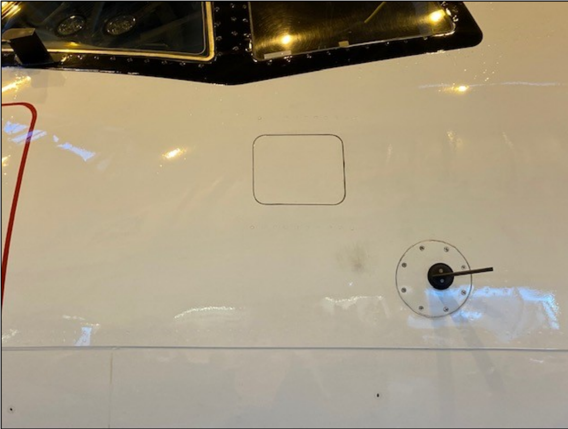
Kuva 2. Ohjaamon kommunikointiluukku (Kuva: Otkes)
