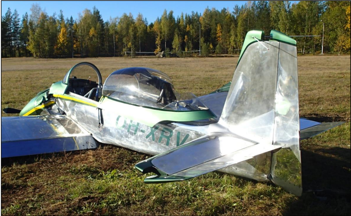
Kuva 6. Lentokoneen kuomun kiskot olivat vääntyneet ja kuomun takaosassa oli noin 40 cm halkaisijaltaan oleva reikä. (Kuva: OTKES)
