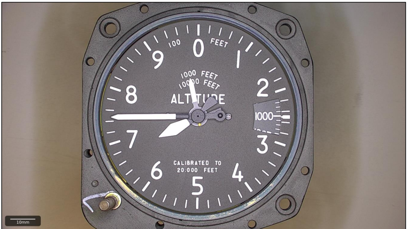
Kuva 17. Mittarin näyttämä barometrisäädön jälkeen. (Kuva: Insta ILS Oy, Käyttöoikeudet: OTKES)
