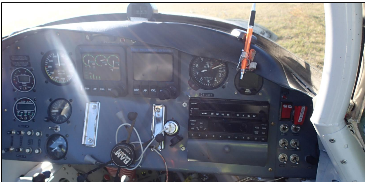
Kuva 7. Lentokoneen mittaritaulu ja kojelauta onnettomuuden jälkeen. Häikäisy suoja on vääntynyt ja mittaritaulu on taipunut keskeltä. (Kuva: OTKES)
