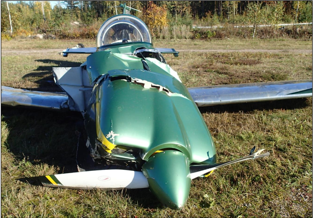
Kuva 5. Lentokoneen runko oli revennyt ja rungon etuosa oli kiertynyt edestä katsottuna oikealle. (Kuva: OTKES)
