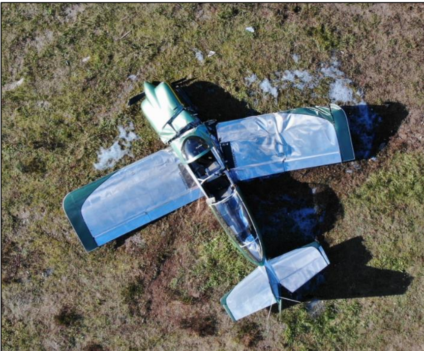
Kuva 4. Lentokone maahan törmäyksen jälkeen. Lentokoneen oikea siipi on vääntynyt törmäyksen voimasta taaksepäin ja revennyt etureunastaan irti lentokoneen rungosta. (Kuva: Poliisi)
