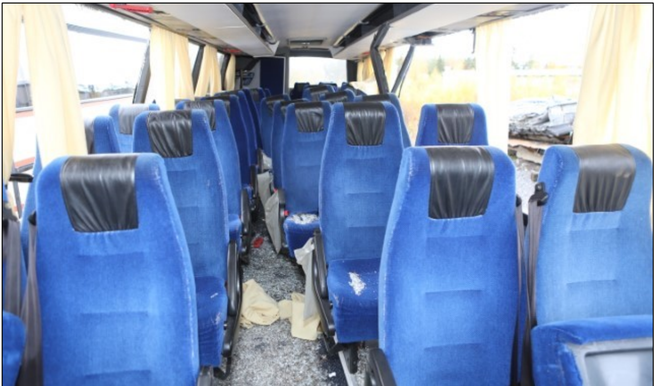
Kuva 5. Linja-auton sisätiloihin irtosi rikkoutuneista sivuikkunoista paljon lasinsirpaleita. Lisäksi osalta penkkiriveiltä irtosivat istuinosat. (Kuva: Poliisi)
