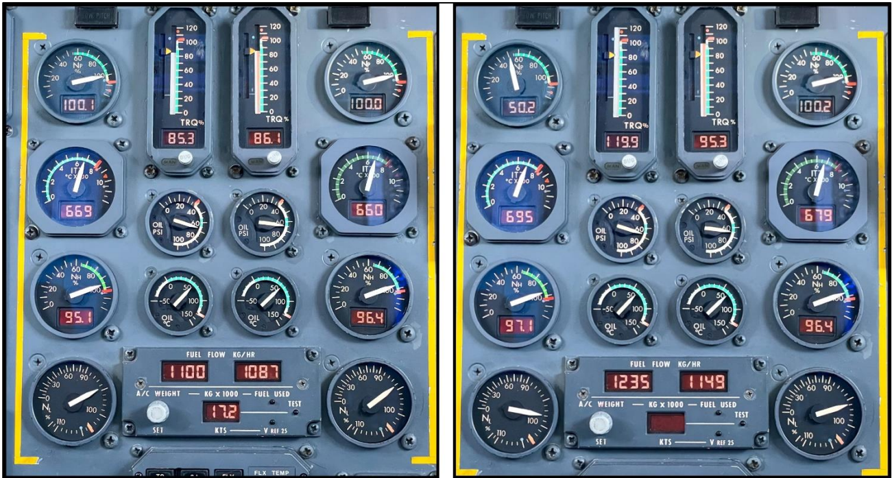
Kuva 3. Vasemmanpuoleisessa kuvassa tilanne normaalissa lentoonlähdössä. Oikeanpuoleisessa kuvassa vasemman moottorin potkuri lepuuttunut, moottori edelleen käynnissä. (Kuvat: Gabriel Leigh / Fliht radar24, merkinnät OTKES).
