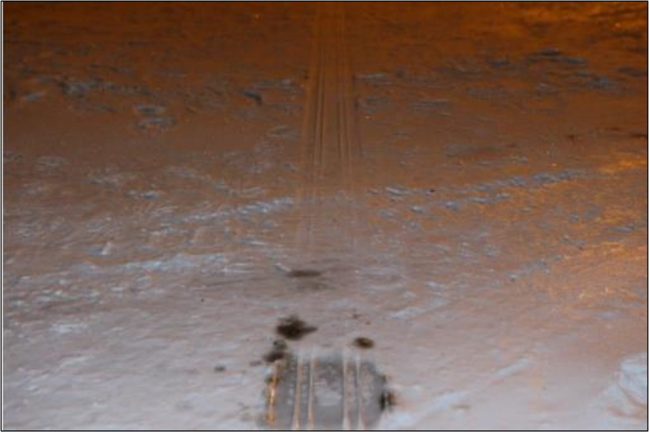
Kuva 10 Onnettomuuspäivän iltana paikkatutkinnassa otettu valokuva toisen päälaskutelineen pyörän rullausjäljestä. Pyörä on ollut pysäköinnin aikana sulaneen laikun kohdalla. Pyörän lumeen jättämien jälkien perusteella pyörät ovat pääasiassa pyörineet. Asematasolla on ollut ohut kerros kuivaa, pakkautunutta lunta, jonka päällä on ollut hieman irtolunta. (Kuva: OTKES)
