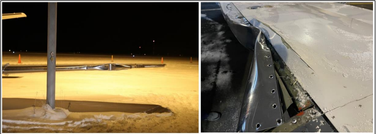
Kuva 4 Lommo lentokoneen vasemman siiven johtoreunan alueella ulottuu siipisalkoon saakka. (Kuvat: OTKES)
