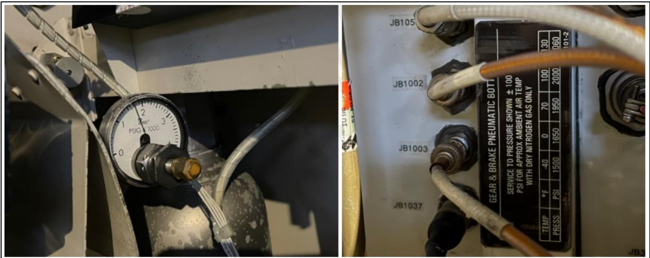
Kuva 8 Häätäjarrujärjestelmän (Emergency Brake) painemittari näytti lentokonehallissa 8.12.2021 tehdyssä tarkistuksessa lukemaa noin 1720 PSI, joka on tarkastustaulukon mukaan riittävä määrä vallinneessa lämpötilassa. (Kuva: OTKES)
