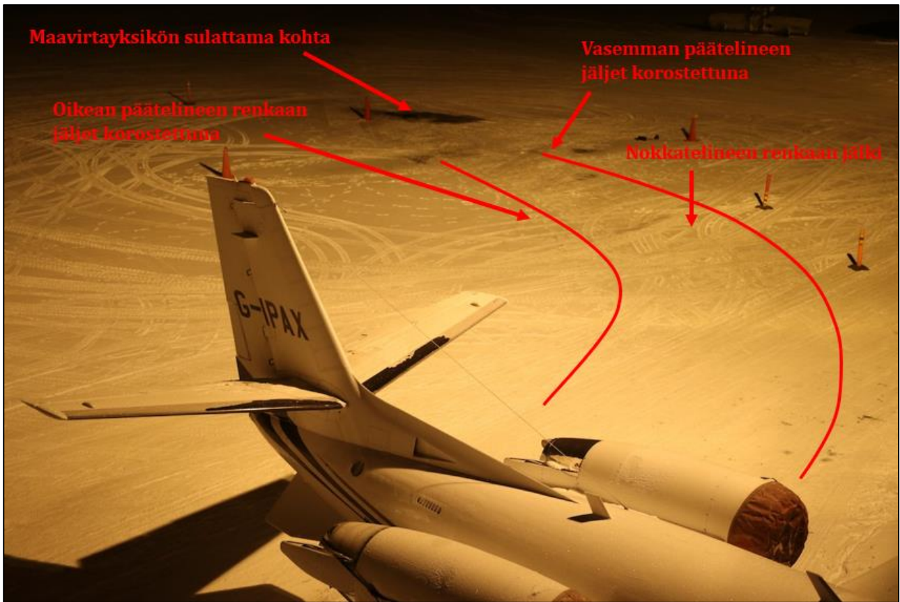
Kuva 2 Lentokoneen rullausreitti on korostettu kuvassa punaisilla viivoilla ja se perustuu lumeen painautuneisiin pyörrien jälkiin. Kuva on otettu tapahtumapäivän 5.12.2021 iltana ennen kuin lentokonetta on siirretty. Kuvan yläosassa erottuvat pyöräpukit on siirretty paikaltaan ja maavirtayksikkö on viety pois. (Kuva: OTKES)
