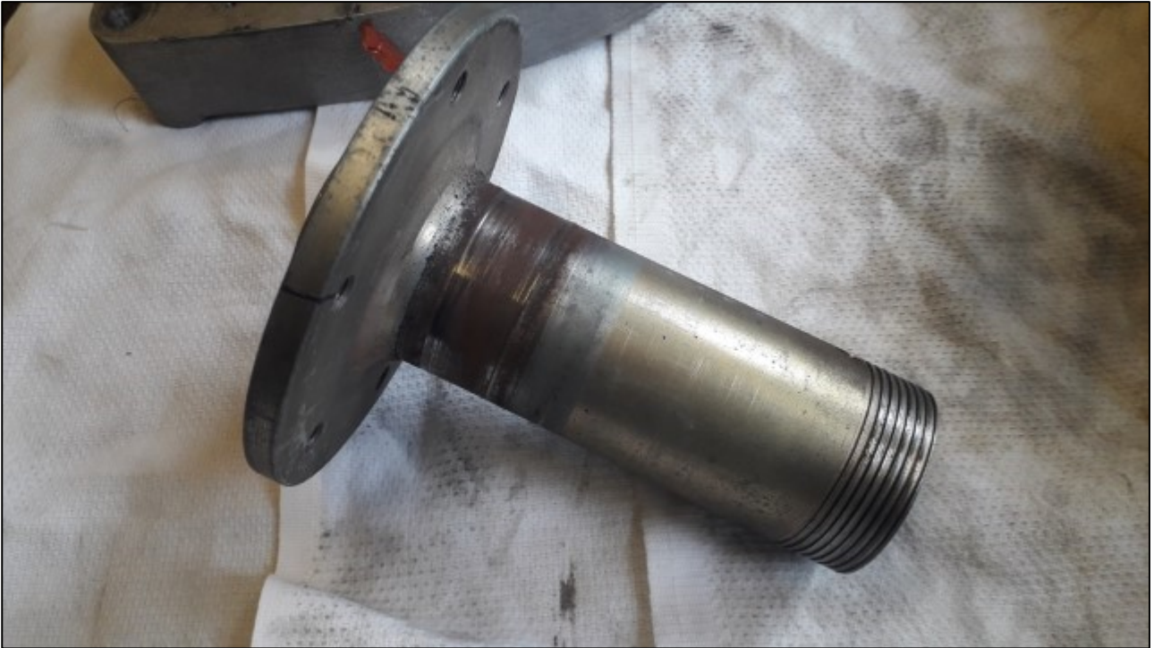
Kuva 11. Potkuriakseli ja potkurin kiinnityslaippa. Akselin vasemmassa päässä on nähtävissä laakerin jättämät hiomajäljet ja ruostepölyä. (Kuva: OTKES)
