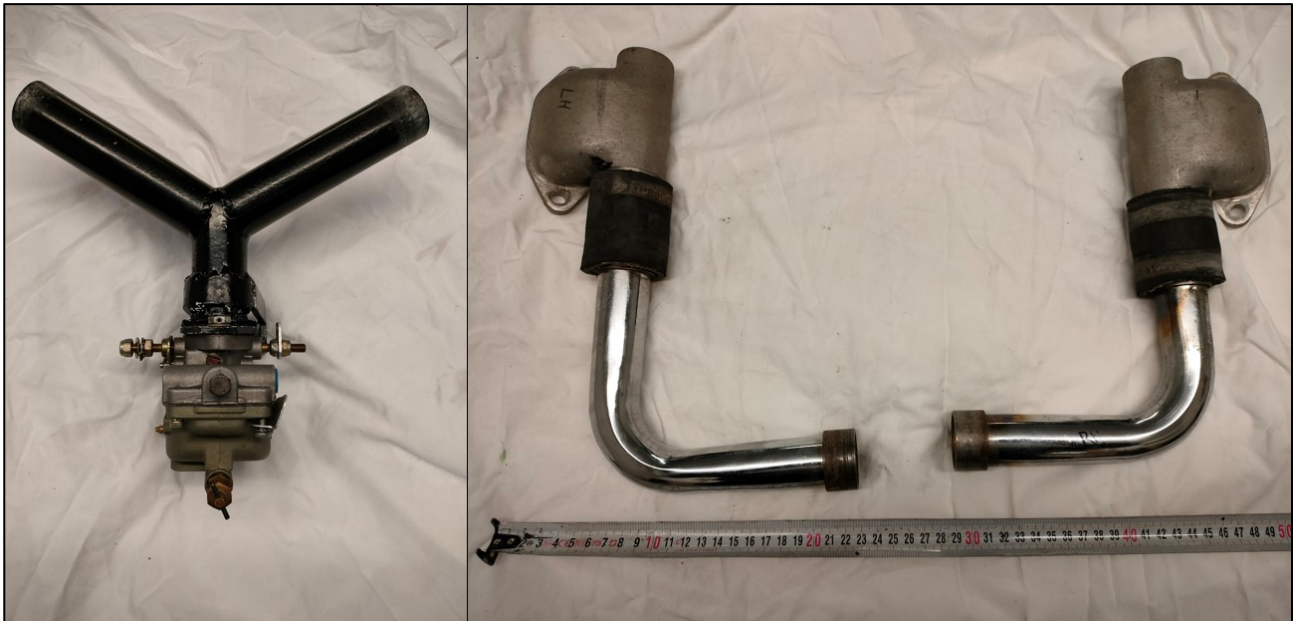
Kuva 3. Vasemmanpuoleisessa kuvassa kaasutin ja imuputkiston y-haara. Oikeanpuoleisessa kuvassa sylinterinkansille menevät imuputket. (Kuva: OTKES)
