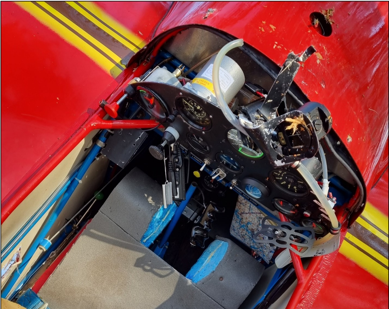
Kuva 8. OH-XMA:n ohjaamo onnettomuuden jälkeen. Mittaritaulu on siirtynyt törmäyksessä taaksepäin. Ohjaussauvan pää ja nopeusmittari sekä kompassi olivat irronneet. (Kuva: OTKES)
