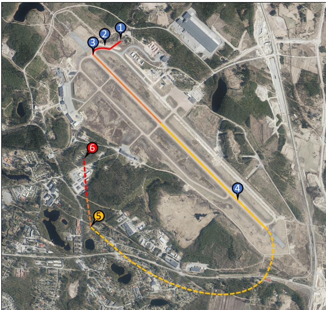
Kuva 1. OH-XMA:n oletettu lentoreitti. Merkkipisteet: 1. Ensimmäinen ilmoitus radioon kello 19.19. 2. Ilmoitus odotuspaikalla A kello 19.22. 3. Ilmoitus lentoonlähdöstä kiitotiellä 12 kello 19.24. 4. Oletettu ilmoituspaikka oikeasta kaarrosta kello 19.25. 5. Oletettu moottorin sammumiskohta. 6. Onnettomuuspaikka. (Kuva: Ortoilmakuva ©Maanmittauslaitos 2/2023, muokkaukset: OTKES)
