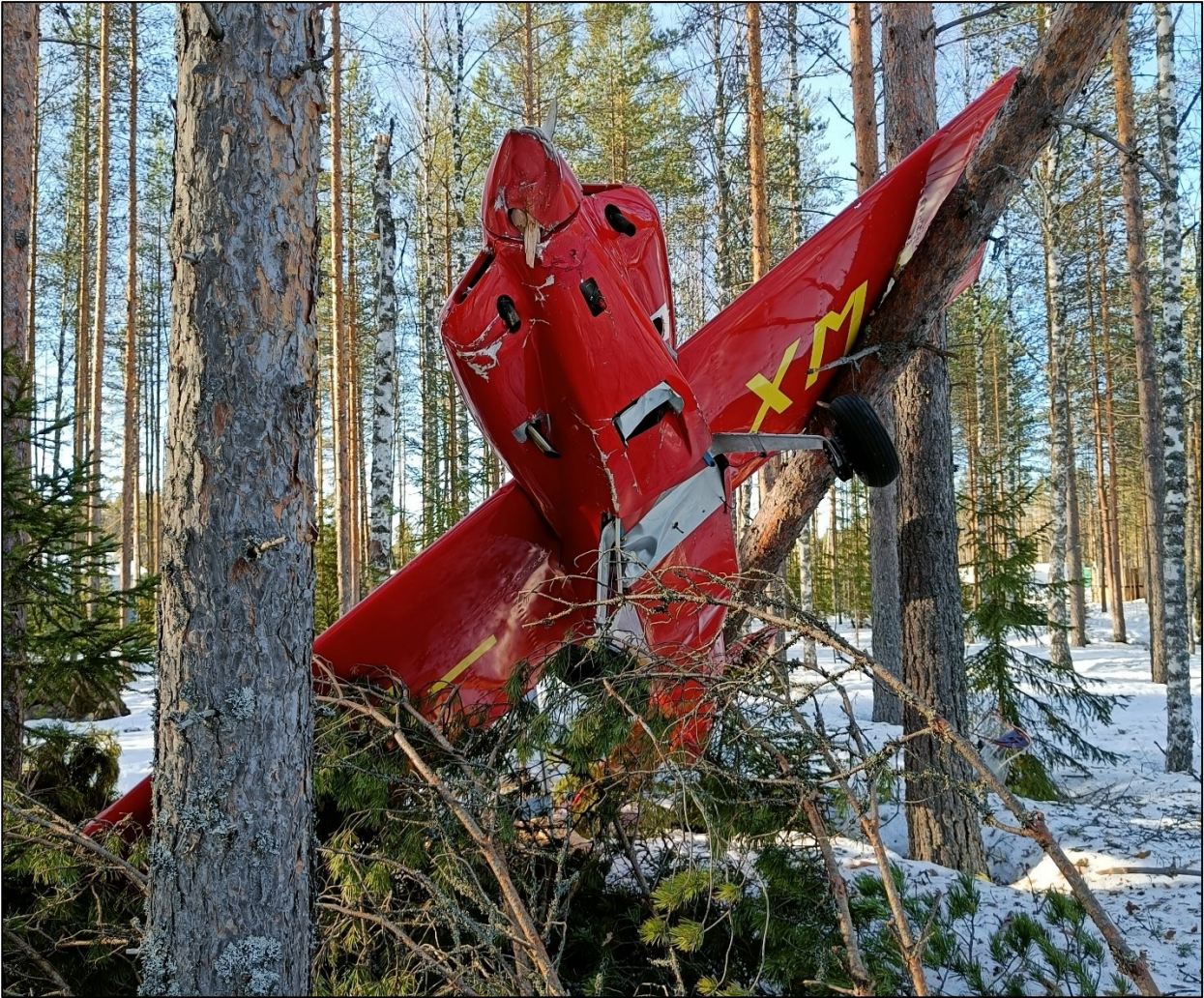
Kuva 7. OH-XMA roikkui onnettomuuden jälkeen kaatuneen männyn varassa. Potkurin lavat olivat katkenneet tyvestä ja potkurikupu oli lommolla. Moottoripellit olivat vaurioituneet törmäyksessä. Oikeanpuoleinen etummainen pakoputki oli vääntynyt. (Kuva: OTKES)
