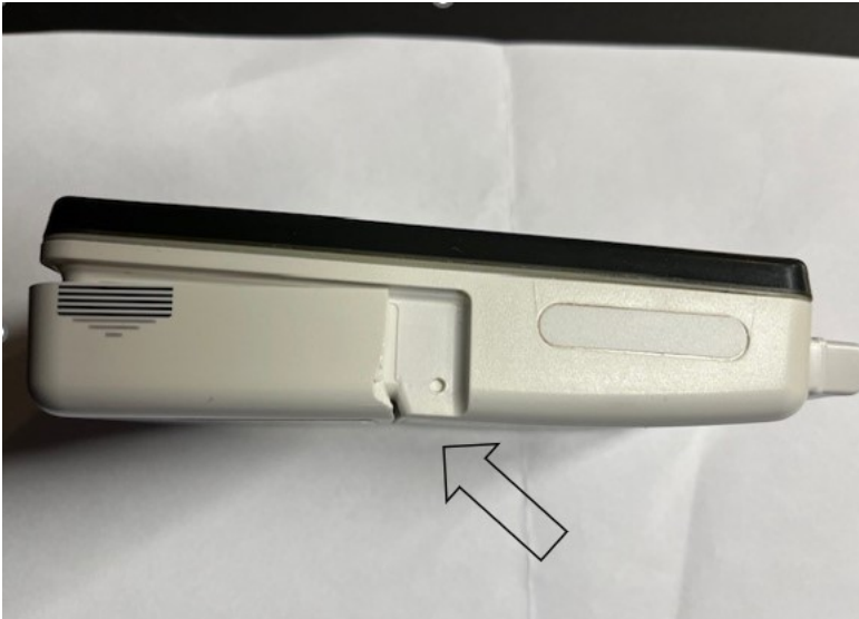
Kuva 6. Akun luukun rikkoutuneet saranat ja rikkoutunut pidike lokerossa. (Kuva: OTKES)
