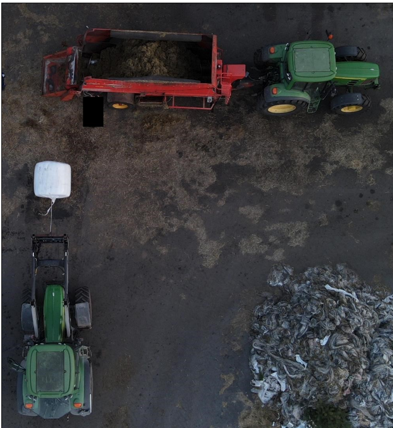
Kuva 18. Tilanne onnettomuuden jälkeen. Kuvan vasemmassa laidassa on seosrehuvaunun lastauksessa käytetty traktori ja muovitettu rehupaali. Kuvan ylälaidassa on traktorikäyttöinen seosrehuvaunu. Vaunussa oli rehuseosta noin neljän keskipainoisen (500 kg) paalin verran. (Kuva: poliisi)
