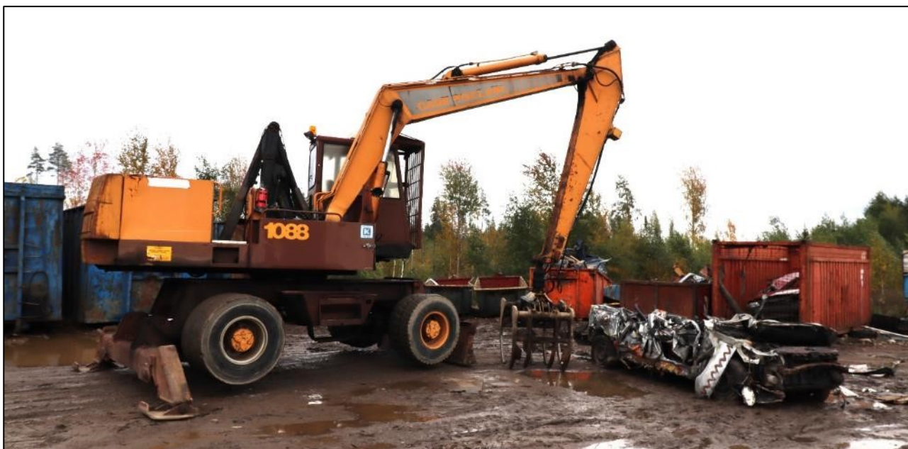
Kuva 38. Rekonstruktio onnettomuuden jälkeisestä tilanteesta. Työkoneen koura lepäsi maassa ja romutettu ajoneuvo oli renkaillaan. Harjoittelija löydettiin ajoneuvon alta kuolleena. (Kuva: OTKES)
