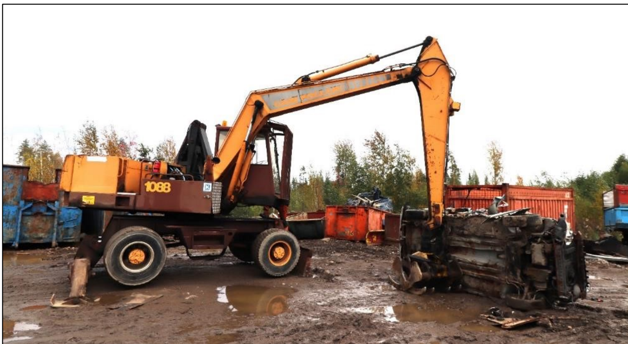
Kuva 39. Työntekijöille ohjeistettu työmenetelmä, jossa ajoneuvo nostetaan kyljelleen ja tuetaan työkoneen puomilla. (Kuva: OTKES)
