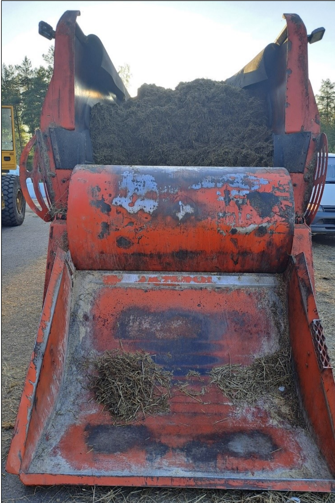
Kuva 21. Onnettomuushetkellä seosrehuvaunun paalikauha oli ala-asennossa ja vaunun takaosa oli auki kuvan osoittamalla tavalla. (Kuva: poliisi)
