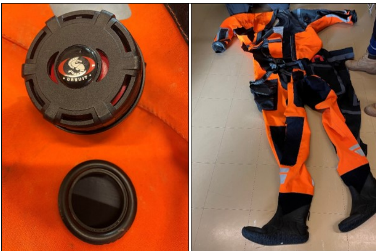
Kuva 53. Vasemmanpuoleisessa kuvassa pintapelastajan puvun tyhjennysventtiili ja venttiilin aukko puvun hihassa. Oikealla pintapelastajan päällä ollut puku. (Kuvat: OTKES)
