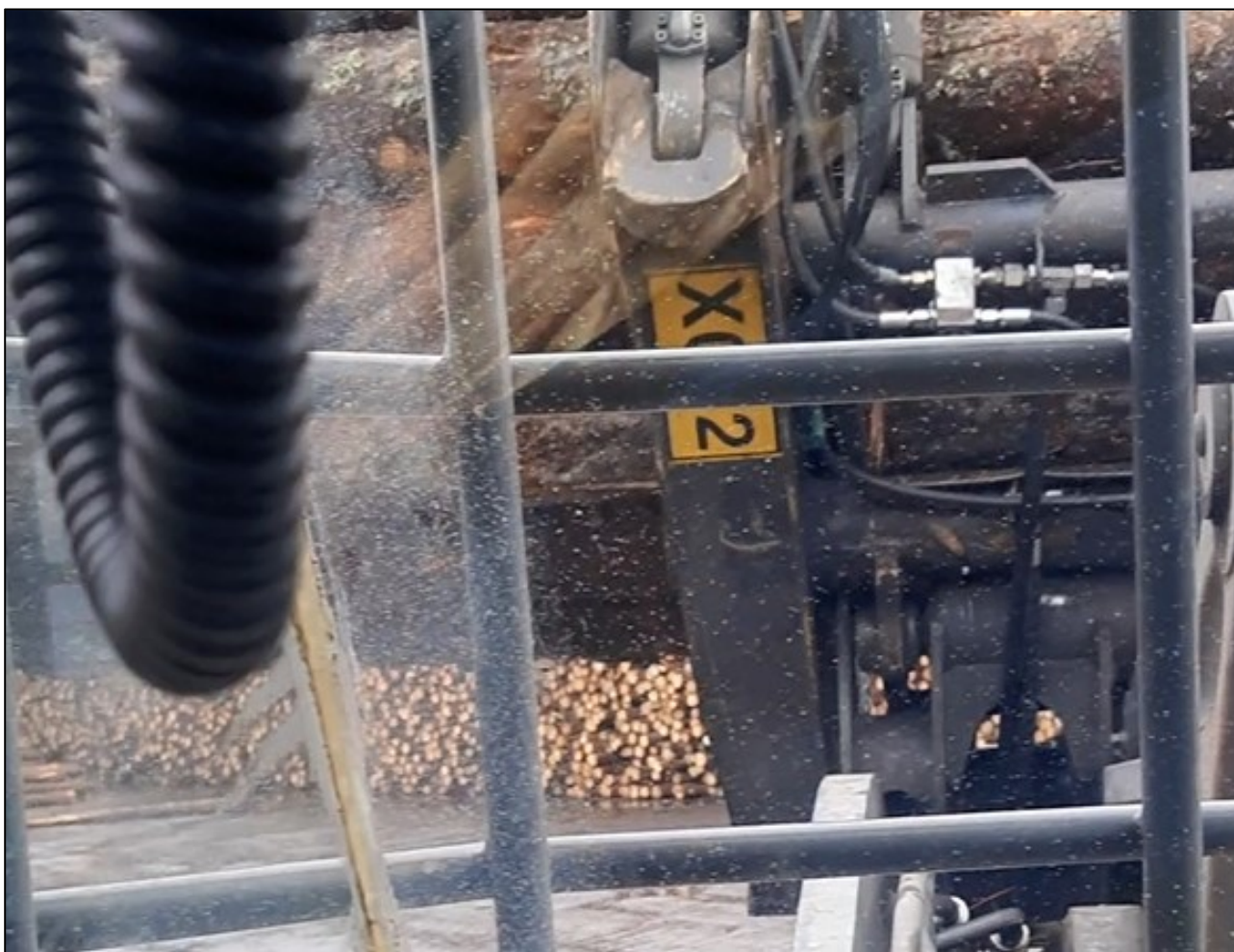
Kuva 43. Kuormatun pyöräkuormaajan ohjaamosta on huono näkyvyys eteenpäin. (Kuva: OTKES)
