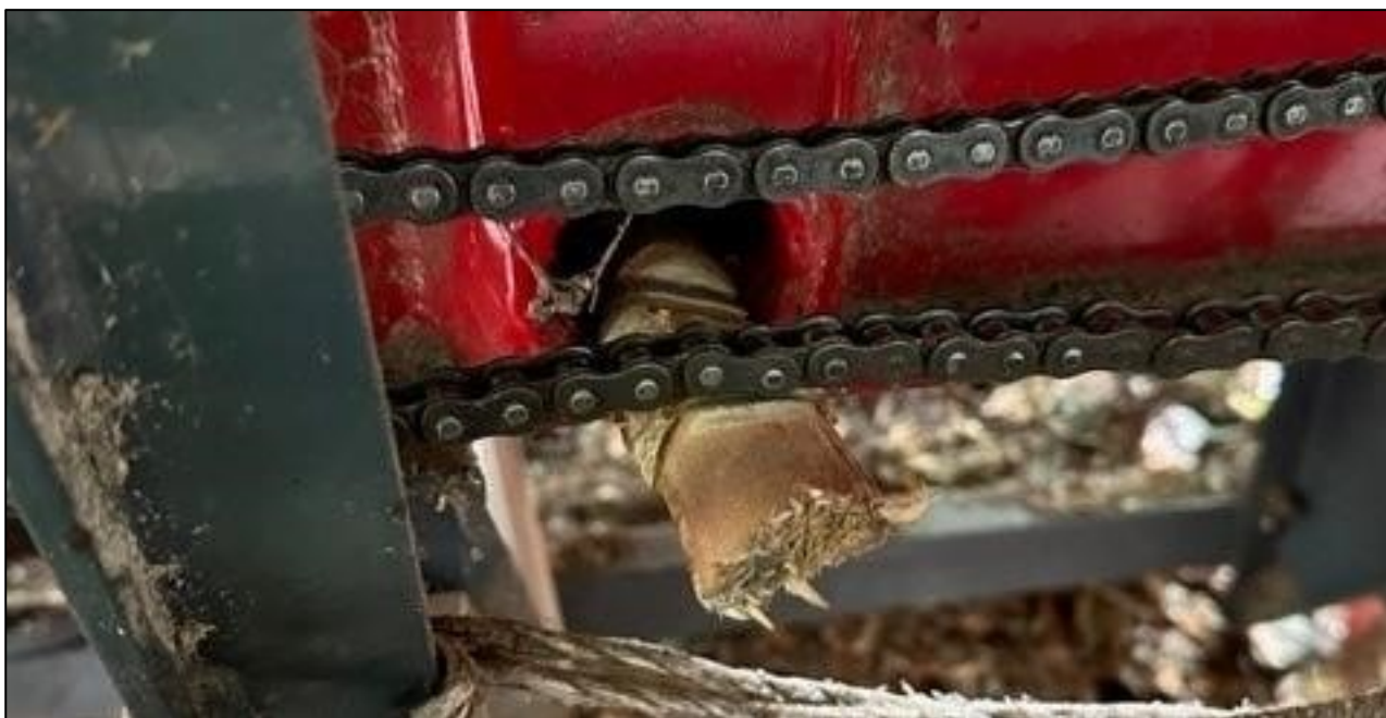
Kuva 26. Esimerkki työkoneisiin tehdyistä omatoimisista korjaustoimista. Tukkipöytään oli puutapilla tehty viritys, jonka avulla pyrittiin pitämään tukkipöydän ketju paikoillaan. (Kuva: OTKES)
