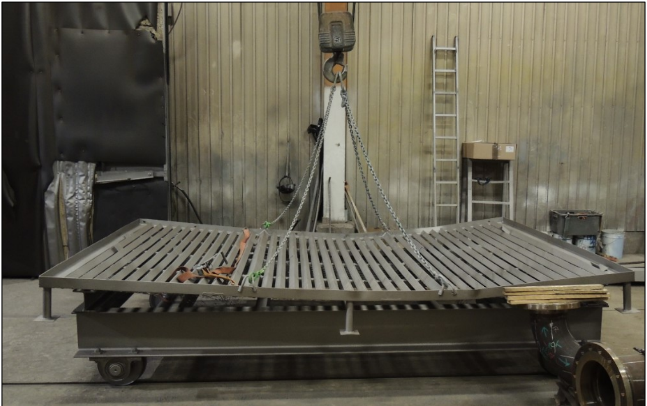
Kuva 45. Vaunu ja metalliverkko, jota käytettiin raepuhallushallissa. Putken ollessa metalliverkon päällä, verkko painuu suoraksi putken painosta. (Kuva: OTKES)
