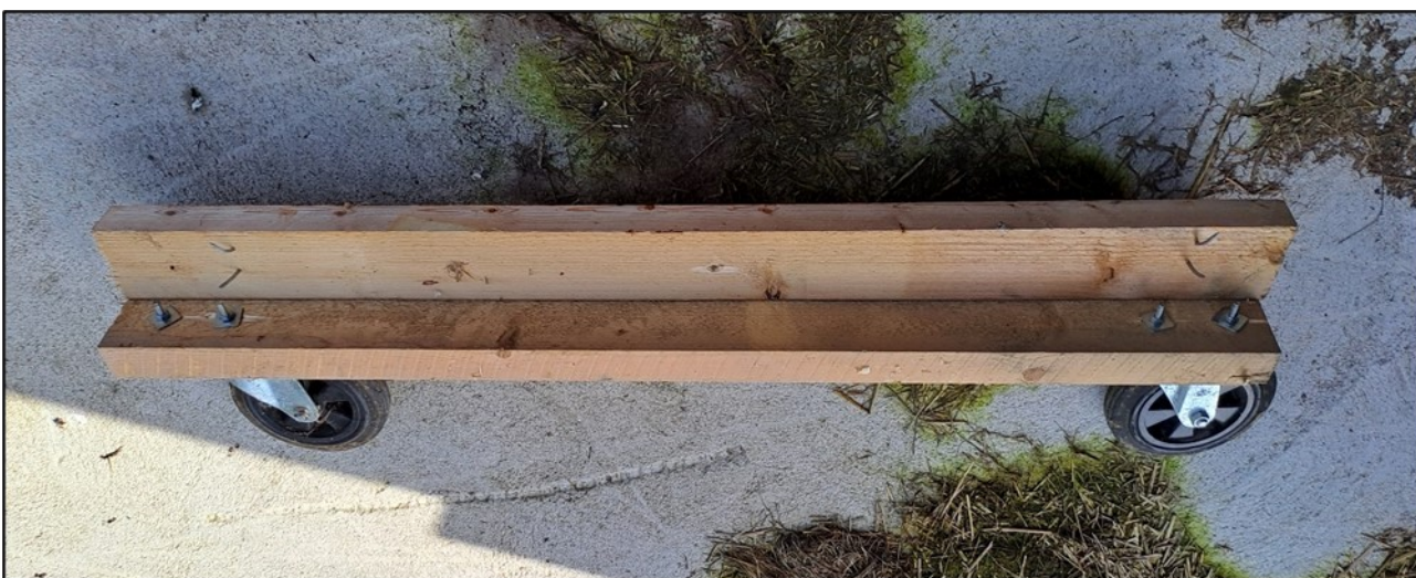
Kuva 34. Irti vääntynyt pyöräosa. Osa oli kiinnitetty telinepukkiin vain nauloilla, jotka vääntyivät irti tapaturmassa. (Kuva: OTKES)
