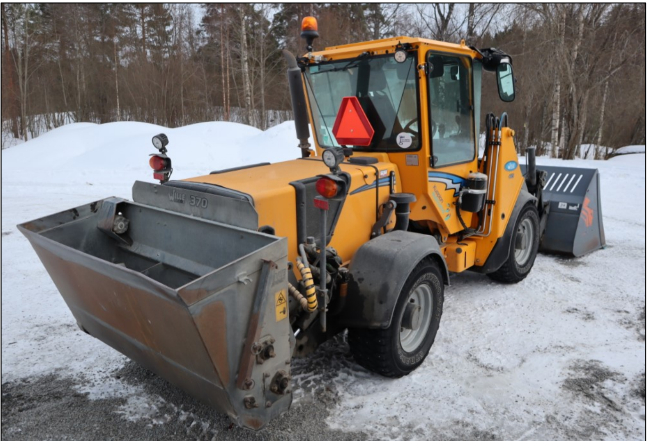
Kuva 12. Työkoneen taakse asennettu hiekoitin, josta työntekijä löytyi kuolleena. (Kuva: OTKES)
