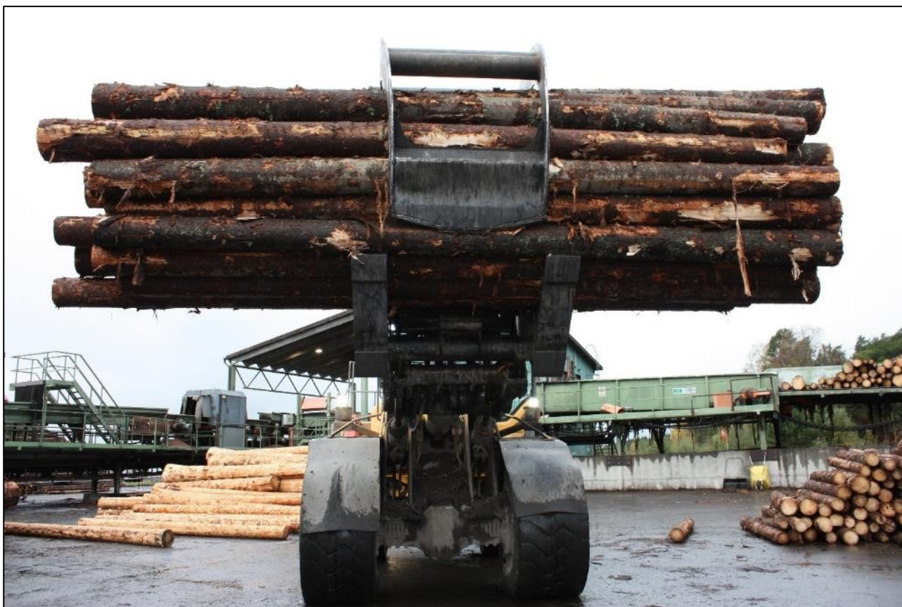
Kuva 42. Pyöräkuormaaaja edestäpäin. Kuvassa kuormaaajan kuormain on arviolta samalla korkeudella kuin onnettomuustapahtumassa. Pyöräkuormaaajan ohjaamo jää kuorman taakse. (Kuva: OTKES)
