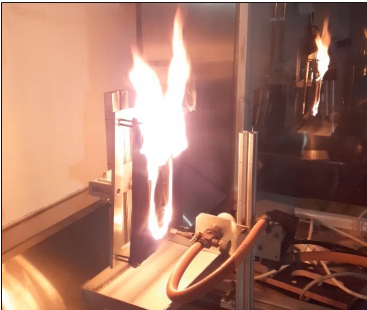
Kuva 17. Tapaturmatapahtumassa käytössä olleiden housujen kangastyypin polttokokeessa. (Kuva-kaappaus SGS Fimko Oy:n videosta: OTKES) 19
