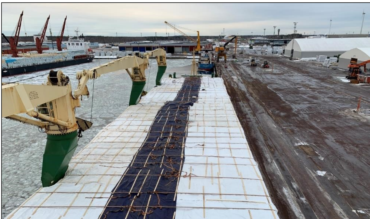
Kuva 7. Suojapeitteillä peitetty kuorma tapahtumaa seuranneena aamuna. Kuorman päältä on maahan noin viiden metrin pudotus. Miehistö ei käyttänyt turvavaljaita. (Kuva: OTKES)
