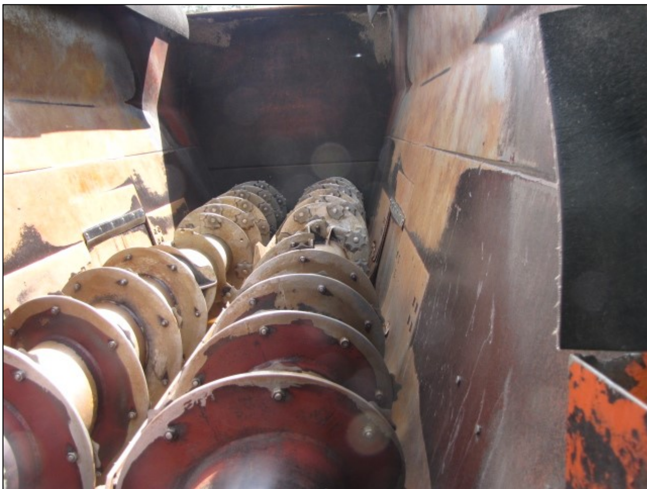
Kuva 19. Onnettomuustapahtuman seosrehuvaunun pohjalla olevat kierukat, jotka silppuavat rehupaalit. (Kuva: OTKES)
