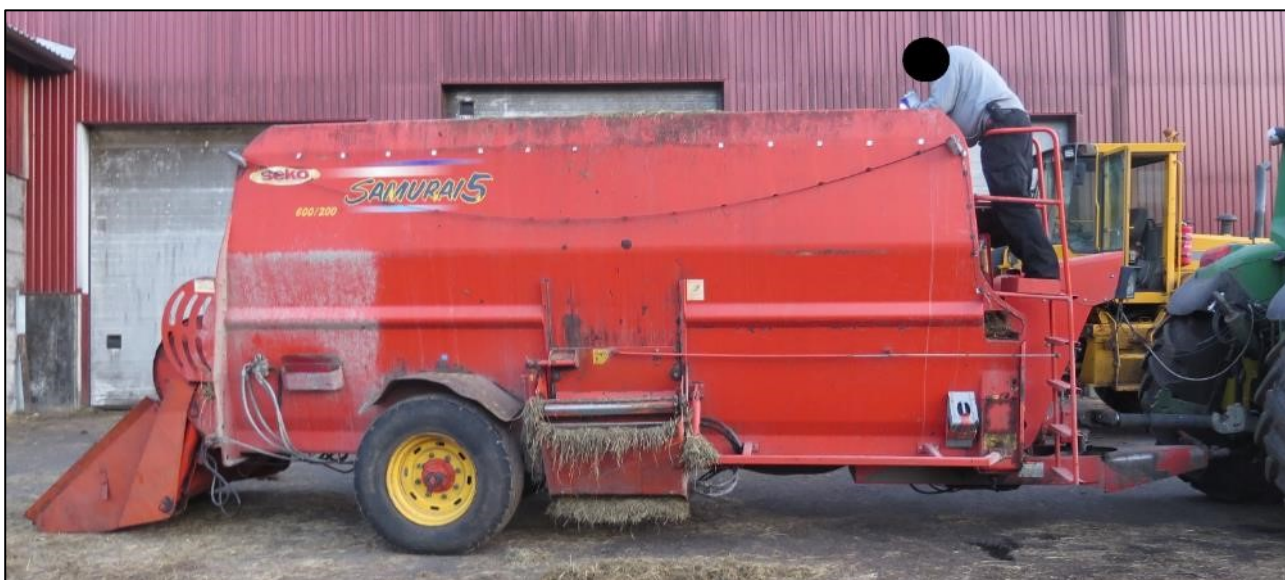
Kuva 20. Onnettomuustapahtuman seosrehuvaunu. Seosrehuvaunun takaosassa olevalla kauhalla (kuvassa vasemmalla) kipataan muovista kuorittava rehupaali vaunuun. Vaunun etuosassa on tikkaat ja tasanne, josta pääsee tarvittaessa katsomaan vaunun sisälle. (Kuva: poliisi)
